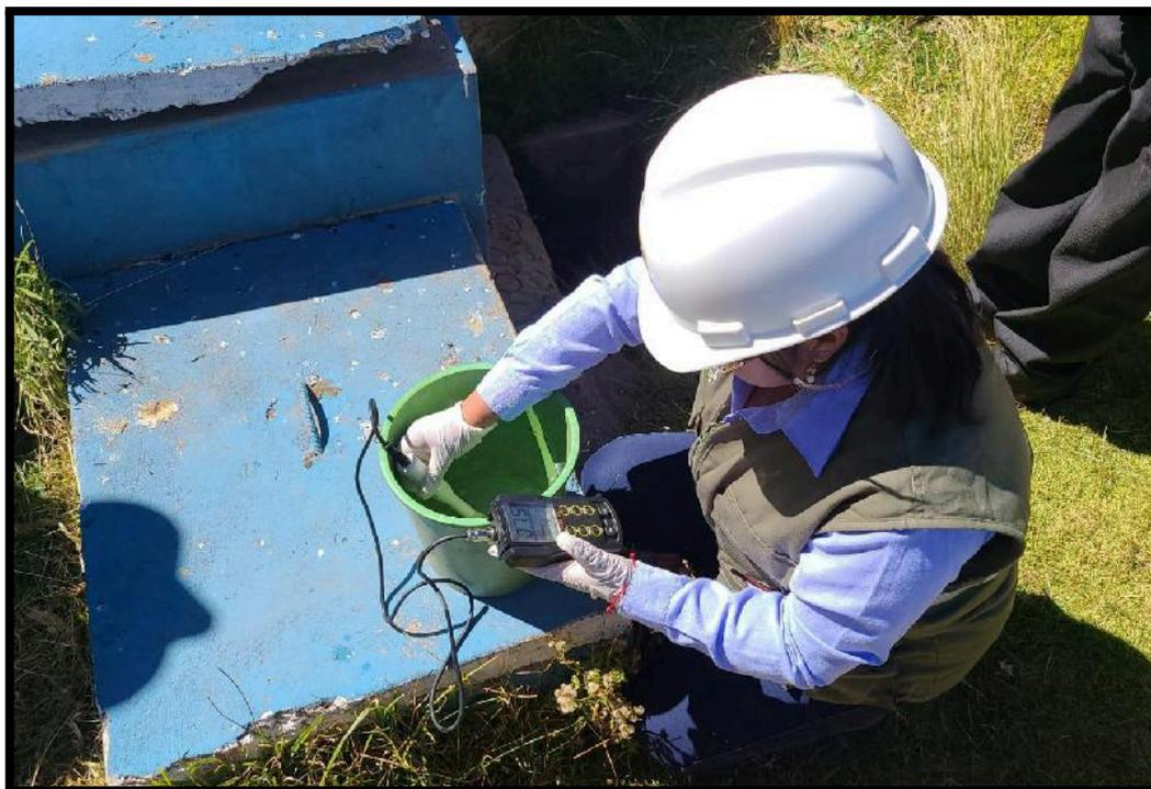
**Figura 09:** Análisis in situ de la muestra del agua del pozo con el multiparamétrico
