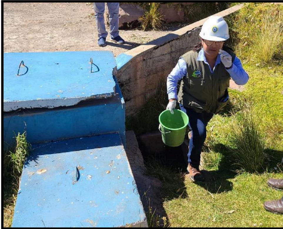
**Figura 08:** Recolección del agua del pozo subterráneo para realizar la muestra
