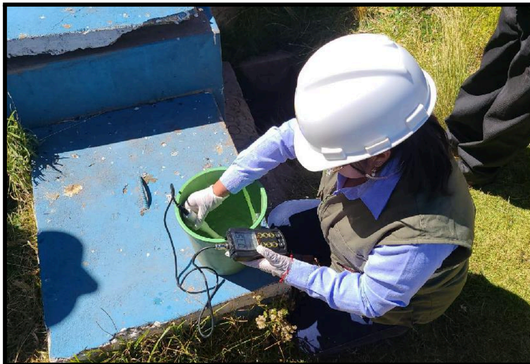
Figura 09: Análisis in situ de la muestra del agua del pozo con el multiparamétrico
