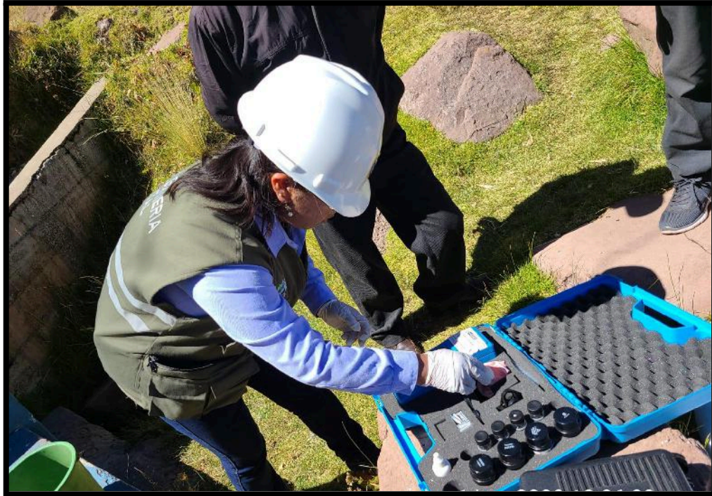
Figura 10: Análisis de agua in situ con el medidor multiparámetro
