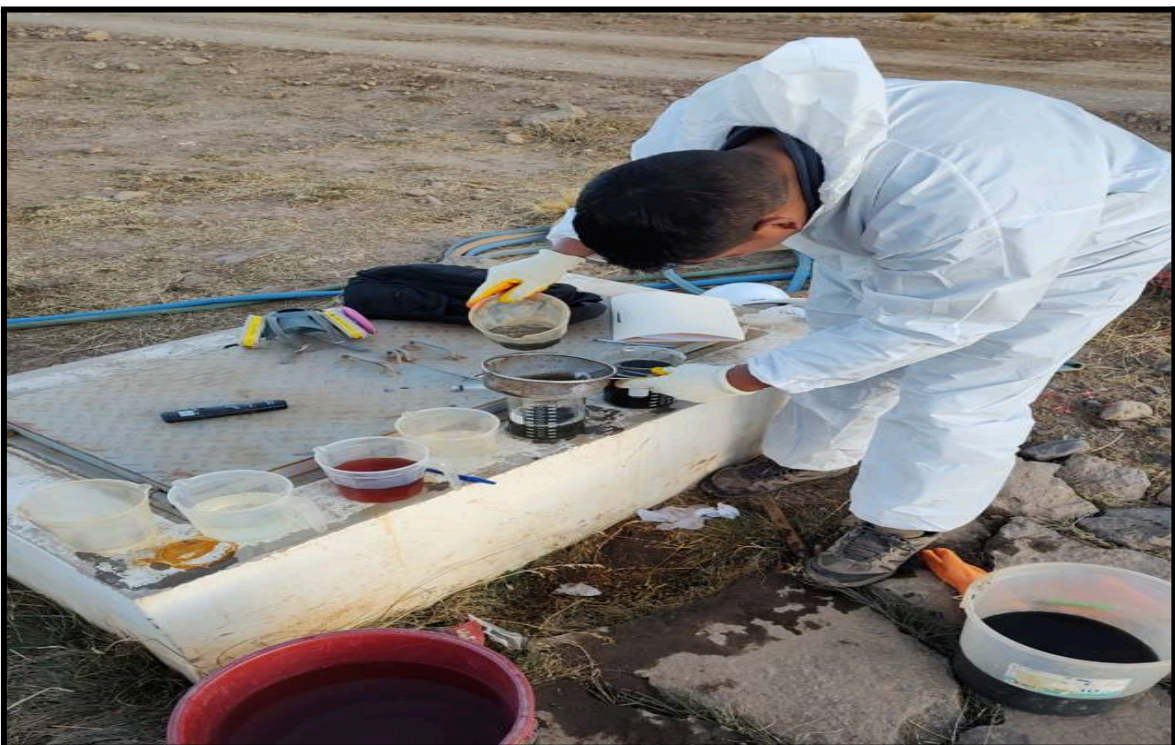
Figura N° 2 Filtrado de lixiviados .
