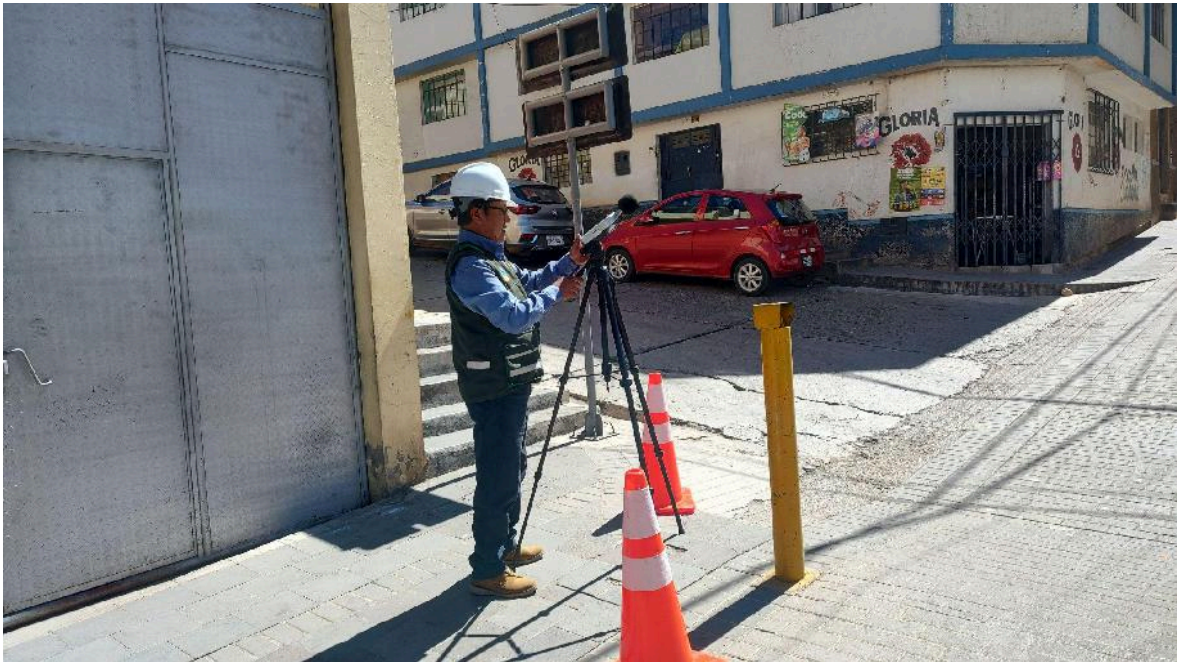
Figura 14: Medición de ruido vehicular en las inmediaciones del centro educativo Villa de Fátima (Jirón Independencia).
