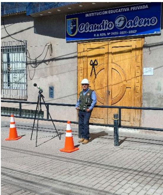
Figura 19: Medición de ruido vehicular en las inmediaciones del centro educativo Claudio Galeno (Jirón Santiago Giraldo).
