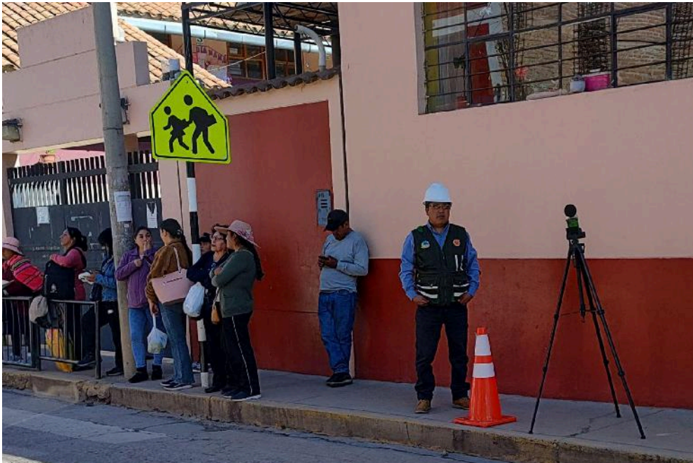
Figura 26: Medición de ruido vehicular en las inmediaciones del centro educativo N° 70005 Corazón de Jesús (Jirón Moquegua).
