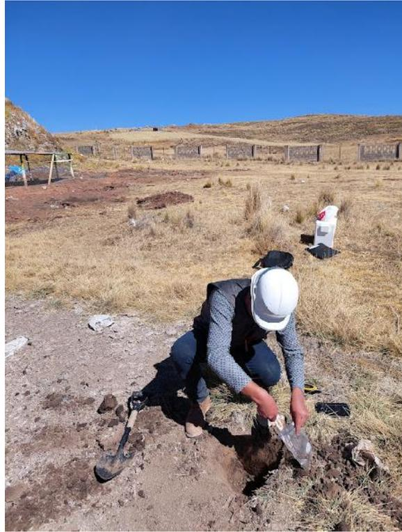
**Figura 23:** Toma de muestra de suelo del punto P2.
