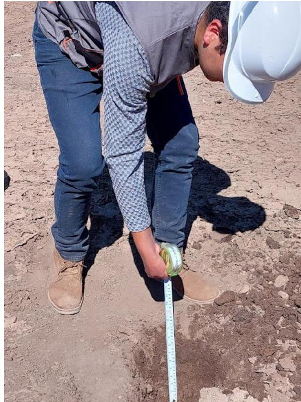
**Figura 25:** Medición de profundidad del punto de muestreo P3.
