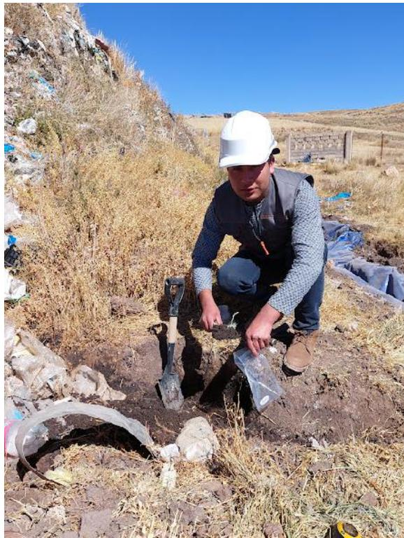
**Figura 18:** Toma de muestra de suelo del punto P1.
