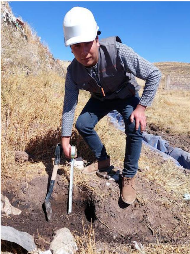
Figura 16: Medición de profundidad del punto de muestreo P1.
