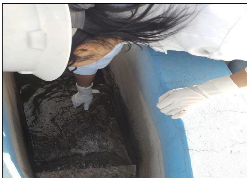
Figura 03: Toma de muestras en el efluente de la PTAR Lampa.
