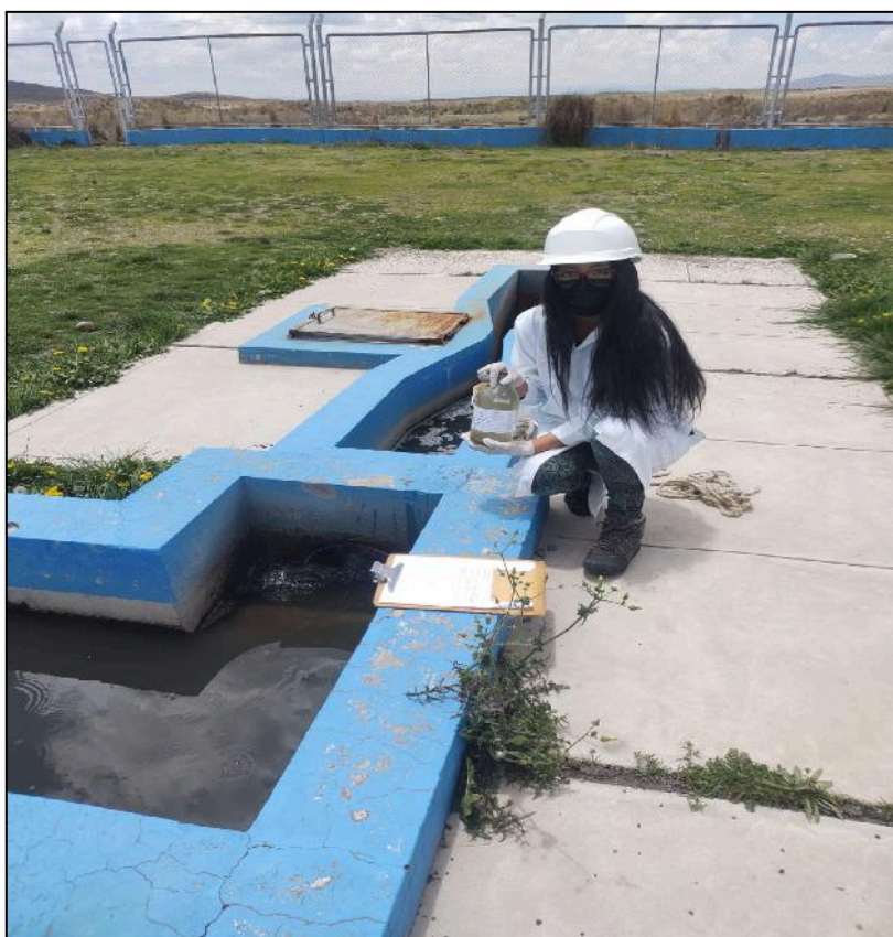
Figura 04: Toma de muestras en el efluente de la PTAR Lampa.
