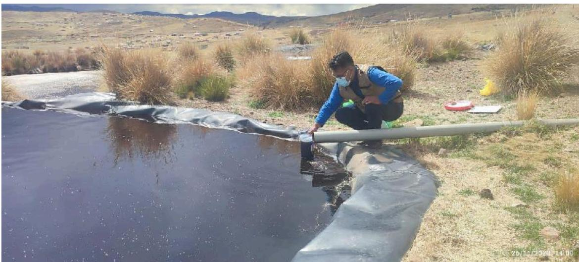
**Fotografía 24.** Extrayendo agua residual para la muestra.
