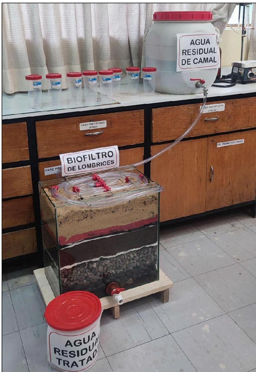
**Figura 05:** Biofiltro implementado.
