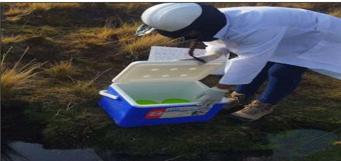
**Figura 09:** Levantamiento de muestras en un cooler para su respectivo análisis en un laboratorio del manantial Titin Phuju.
