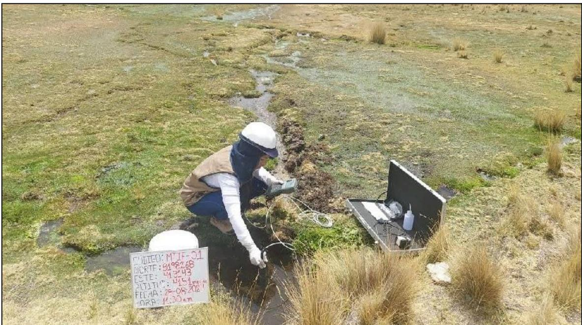
**Figura 07:** Verificación con el multiparametro el Ph del manantial Titin Phuju.
