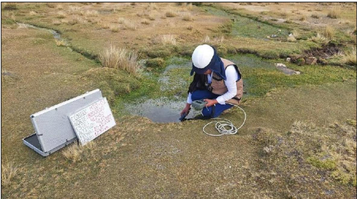
**Figura 11:** Verificación con el multiparametro el Ph del manantial Q'uespi Phuju.
