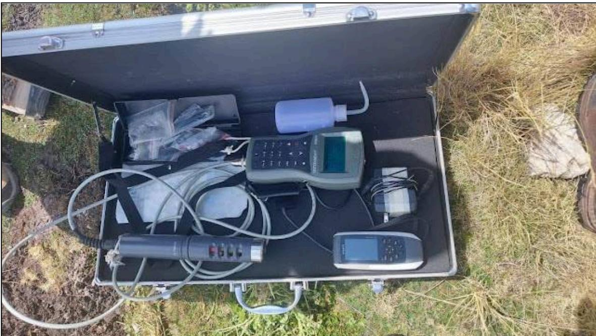
**Figura 05:** Se aprecia en la fotografía el equipo de multiparámetro para el monitoreo de los manantiales Titin Phuju y Q'uespi phuju.
