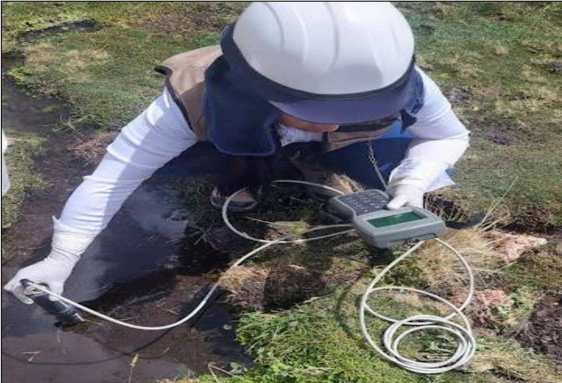
**Figura 08:** Verificación con el multiparametro la conductividad eléctrica del manantial Titin Phuju.
