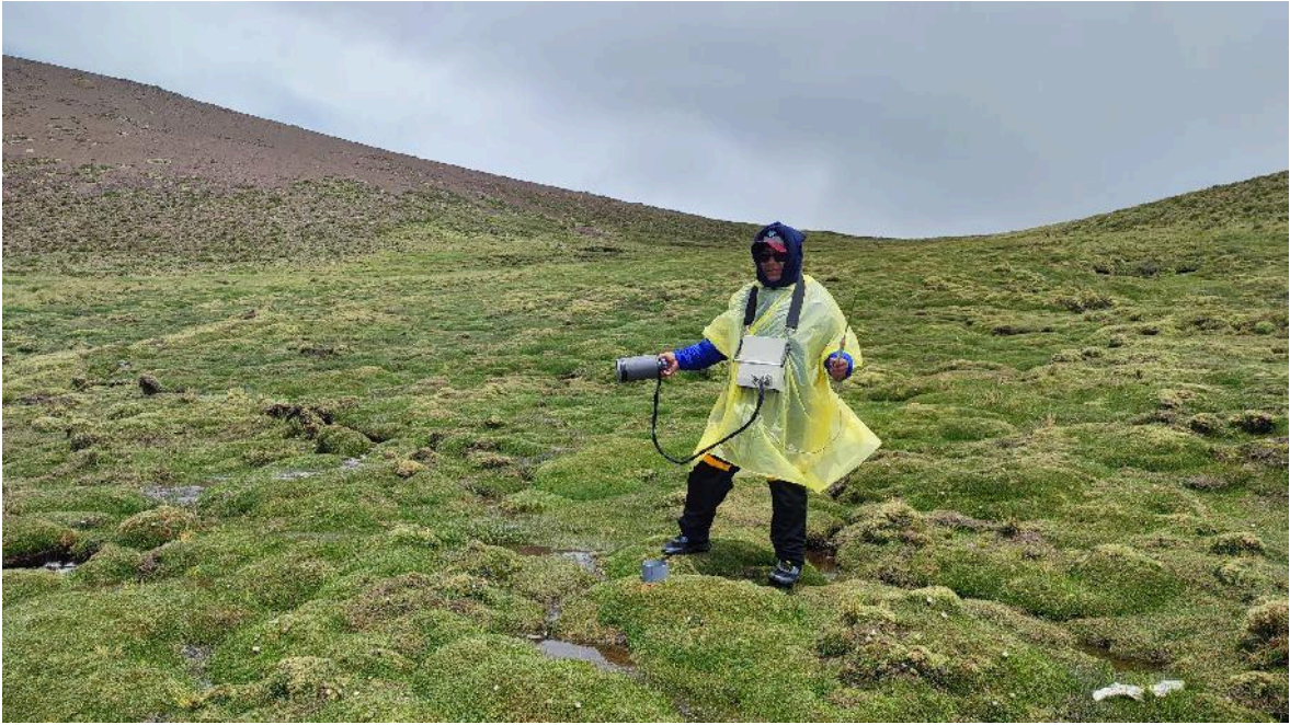
Figura 19: Medición de CO 2 del suelo
