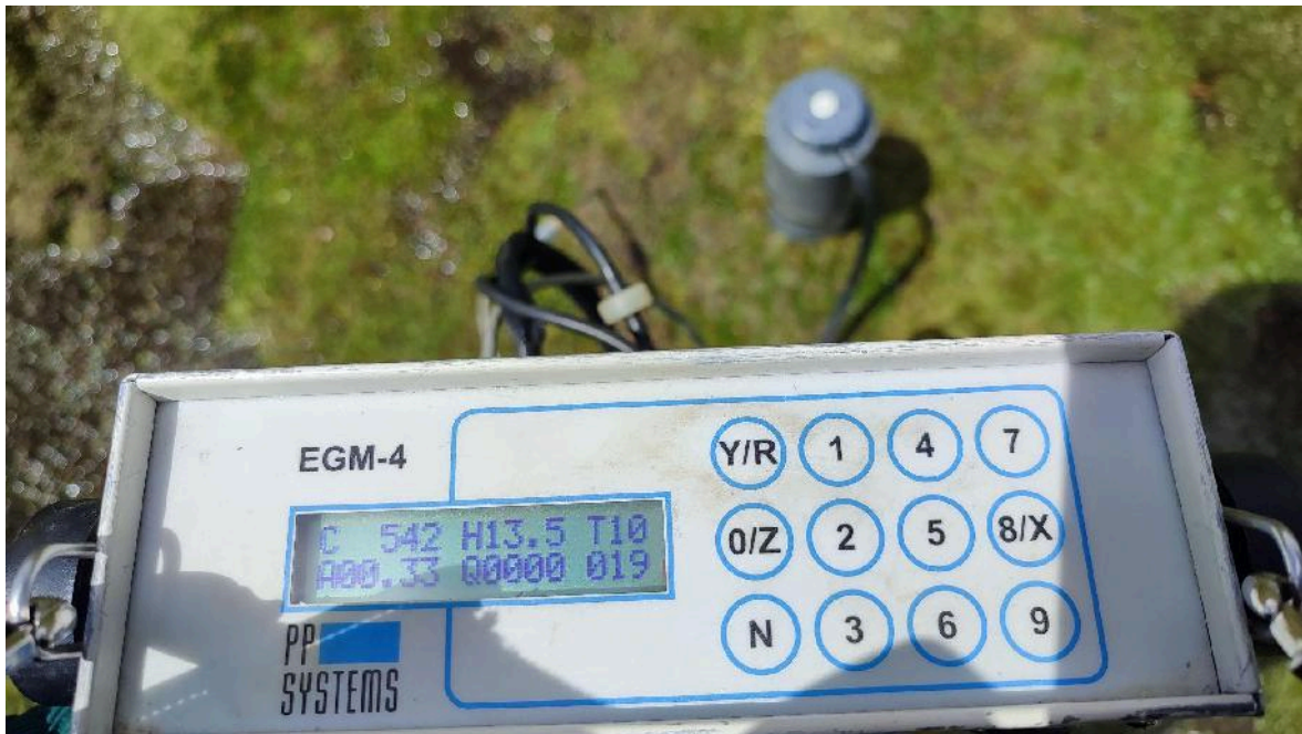
Figura 21: Medición de CO 2 , indica concentración, temperatura, tiempo
