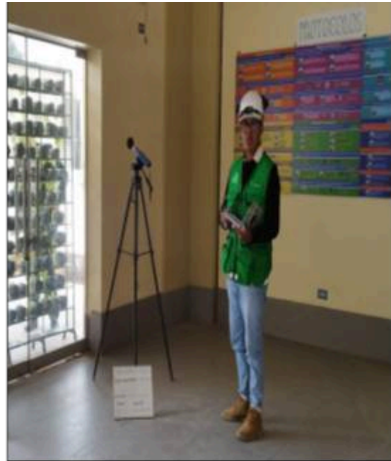
Fotografía N° 06. Medición de ruido considerando el protocolo MINAM N°227-2013.
