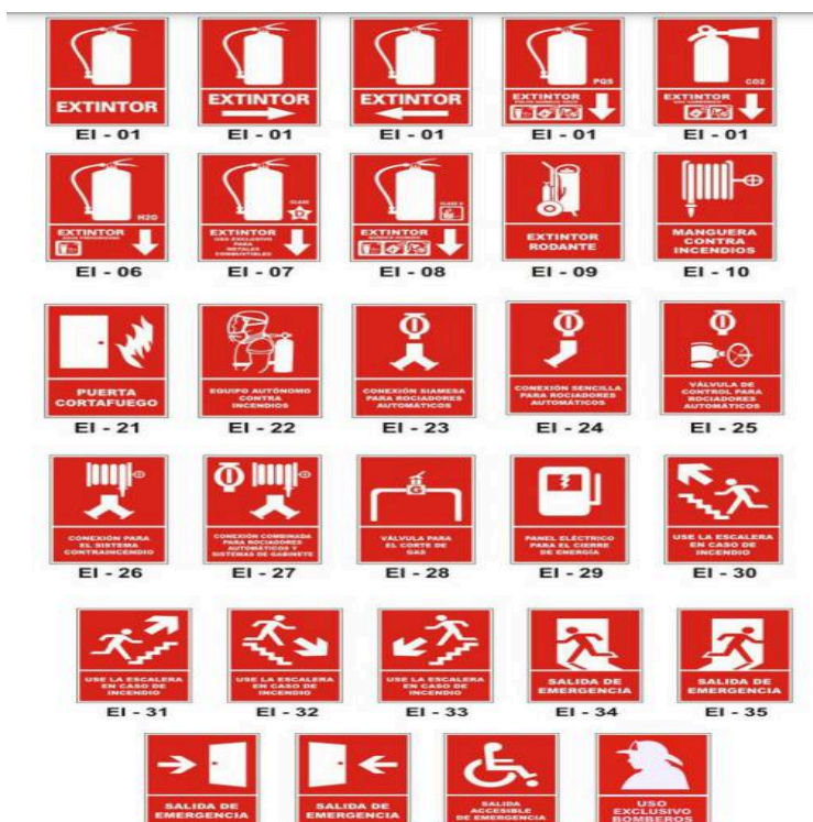
Figura 15: Señales de equipo contra incendios.
