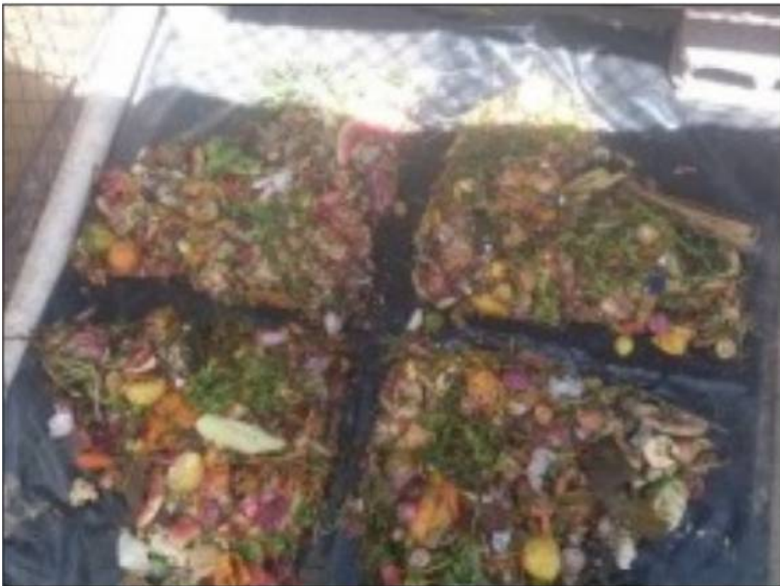
Figura 19: método del cuarteo para los residuos sólidos
