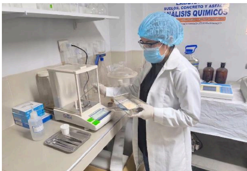
Figura 14: Pesaje analítico de las dosis de PCH para el ensayo de jarras
