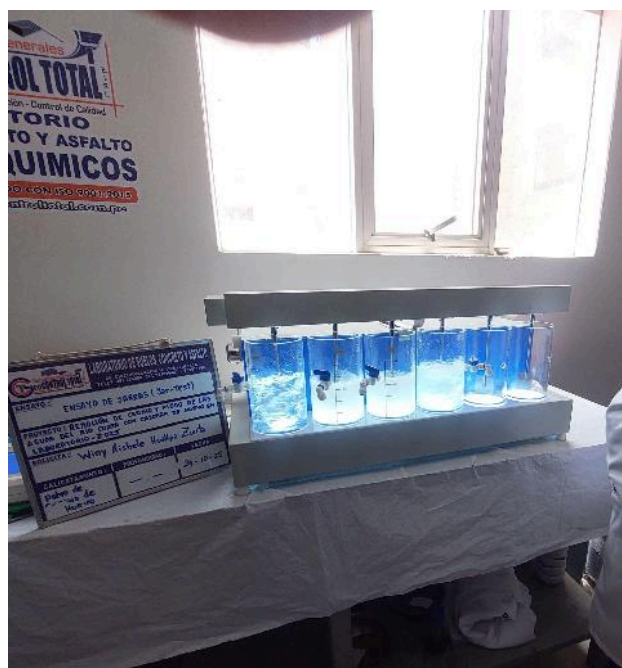
Figura 16: Proceso de agitación en la segunda etapa del ensayo de jarras con cuatro niveles de tratamiento.
