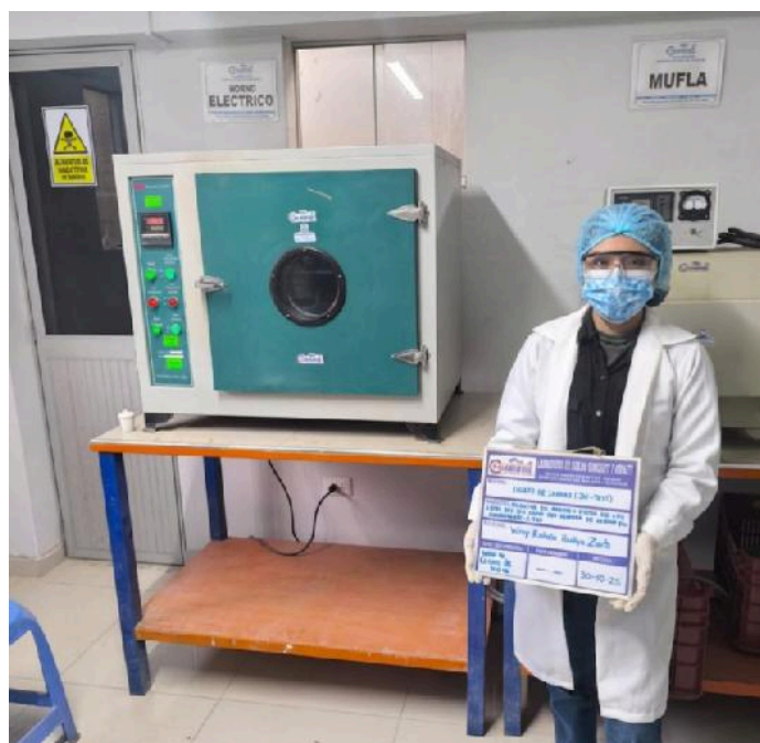
Figura 11: Proceso de secado de las cáscaras de huevo en el horno eléctrico
