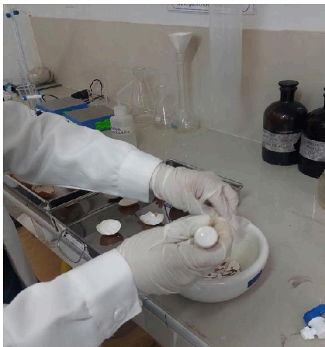
Figura 13: Proceso de molienda de las cáscaras de huevo deshidratadas
