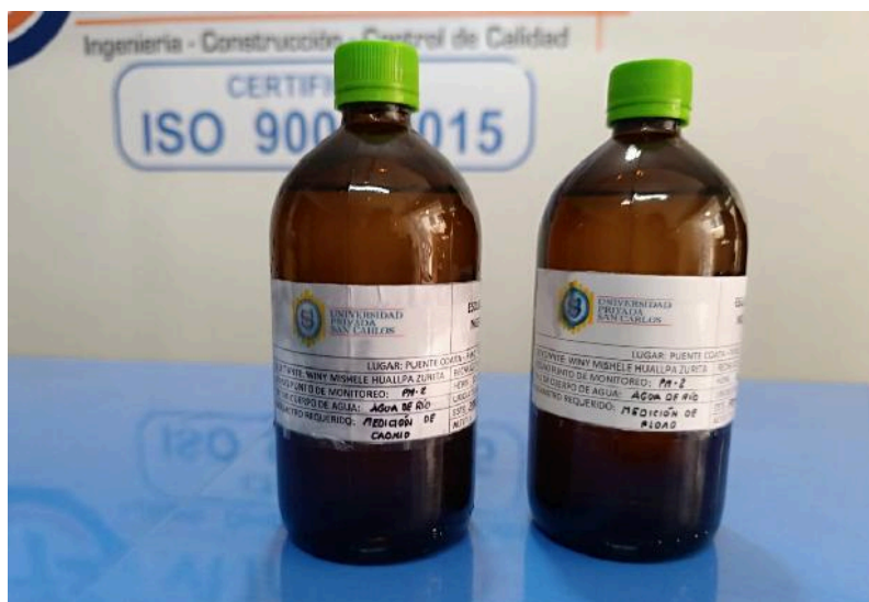
Figura 09: Rotulado y etiquetado de las muestras de agua del río Coata para la determinación de metales pesados (Cd y Pb).
