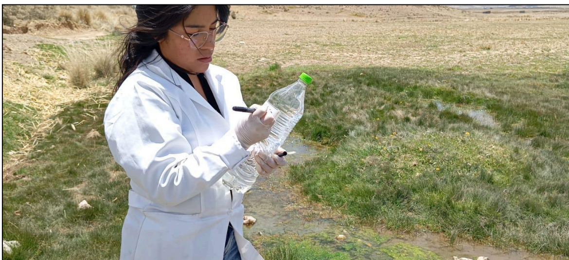
Figura 22: Rotulación de la muestra de agua del pozo P - 2
