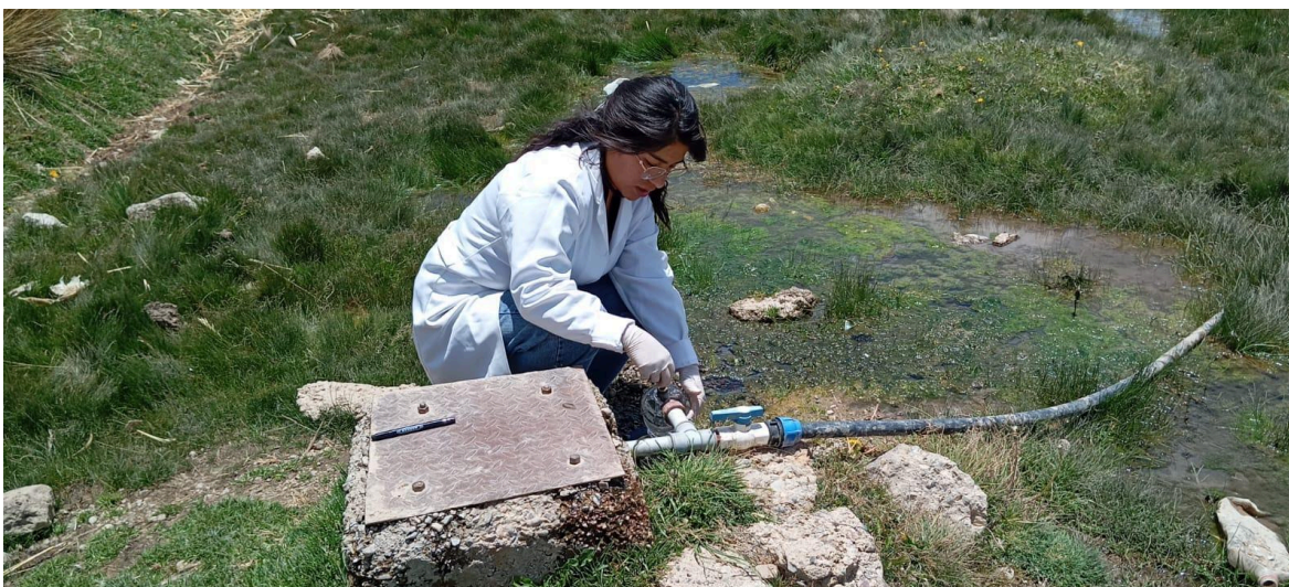
Figura 20:. Extracción de agua del pozo P - 2.
