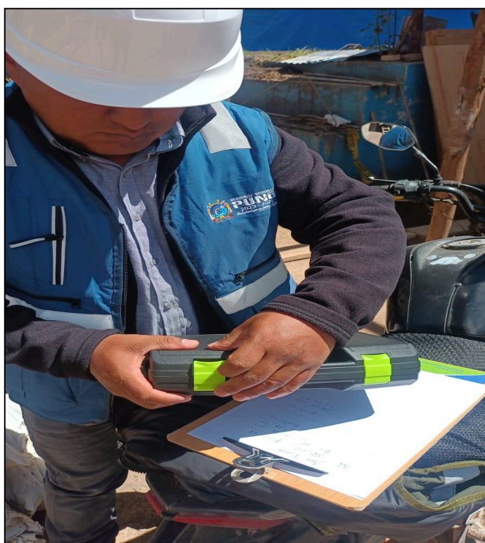
Figura 09: Preparando el armado del sonómetro
