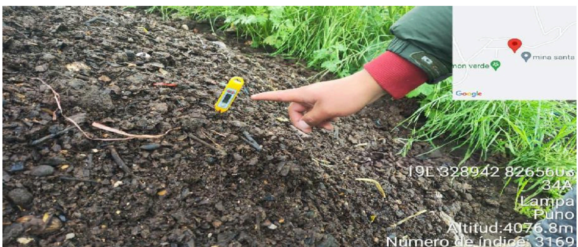
Figura 28: Monitoreo de temperatura en compost maduro.
