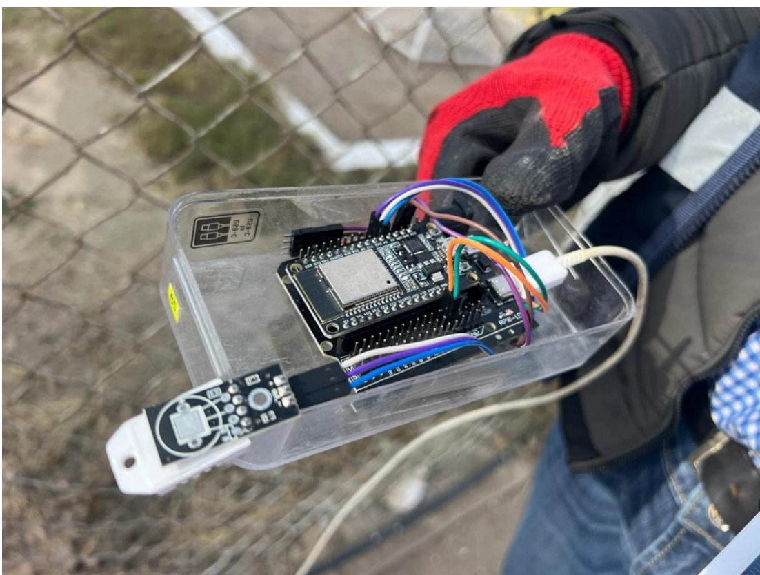
Figura 34: Placa ESP32 y sensor de temperatura y humedad.
