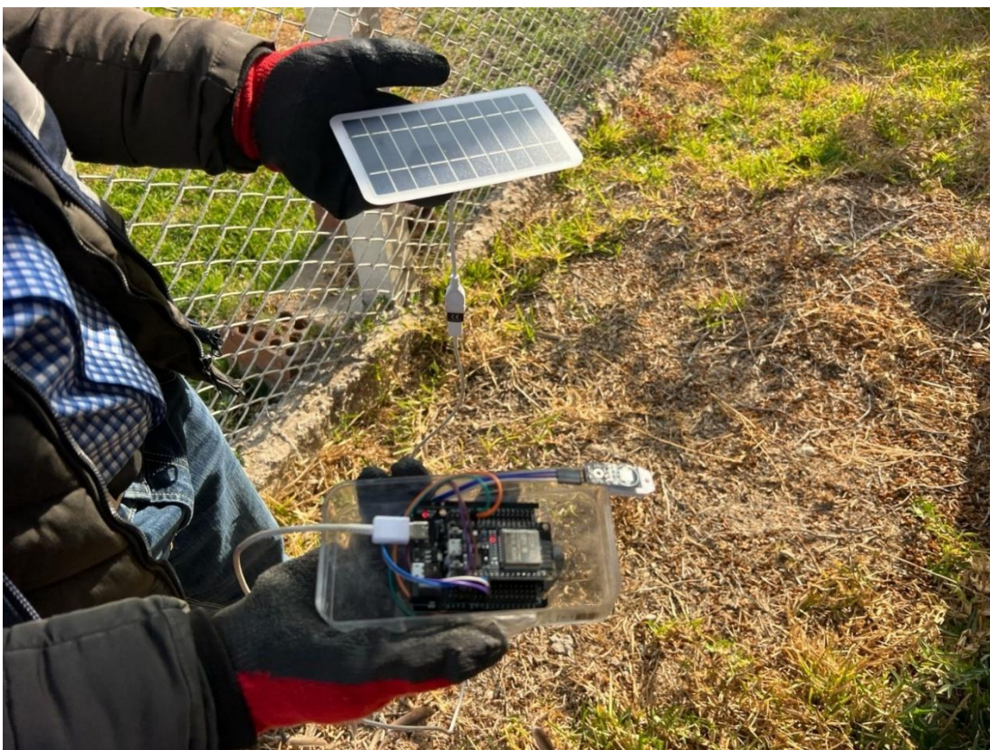
Figura 33: Reconocimiento de conexión eléctrica con panel solar ordinario.
