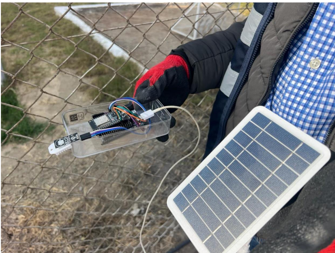
Figura 31: Reconocimiento de conexión eléctrica con panel solar ordinario.
