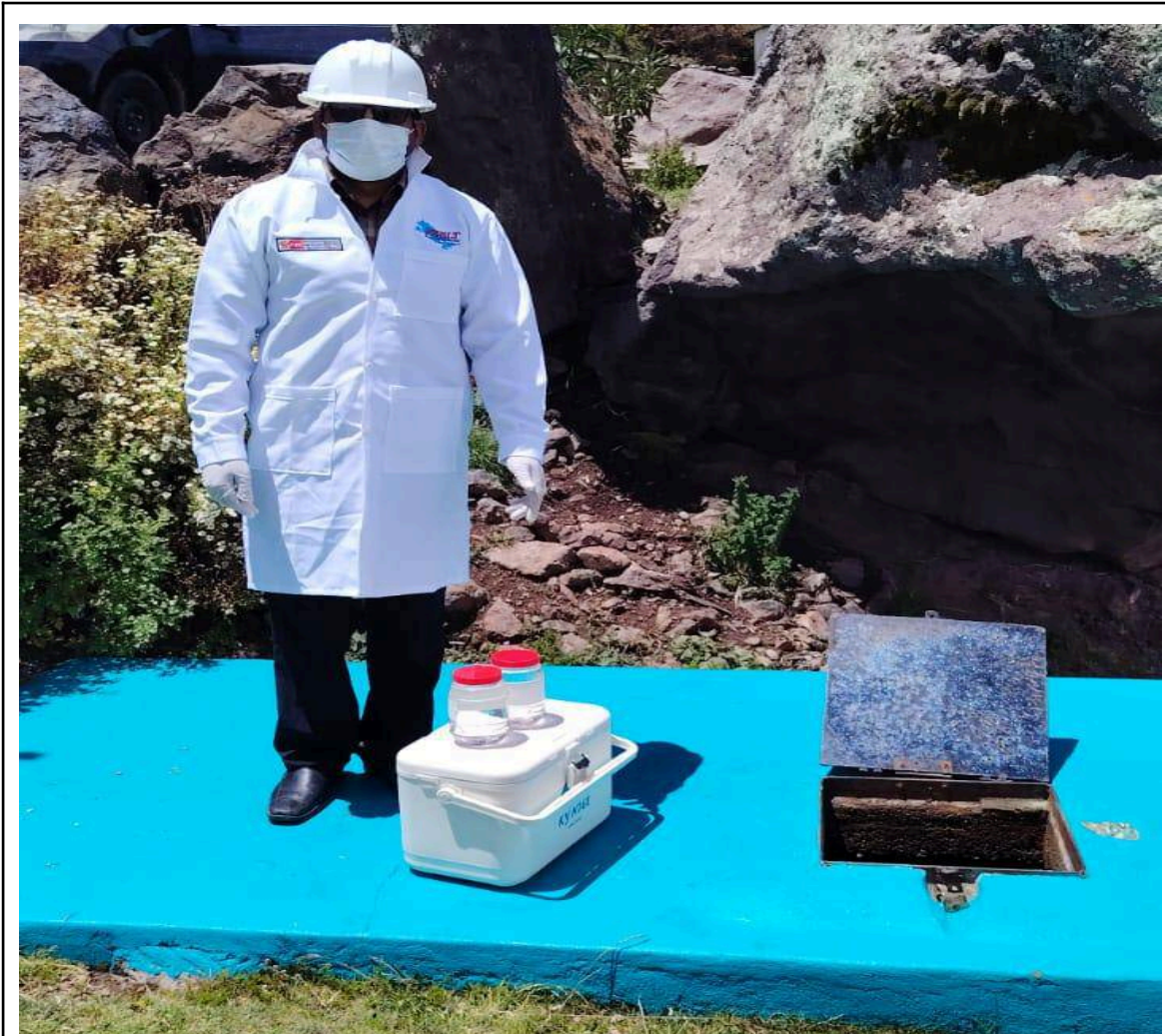
Figura 05. Recolección de muestras de agua para análisis fisicoquímico y microbiológico
