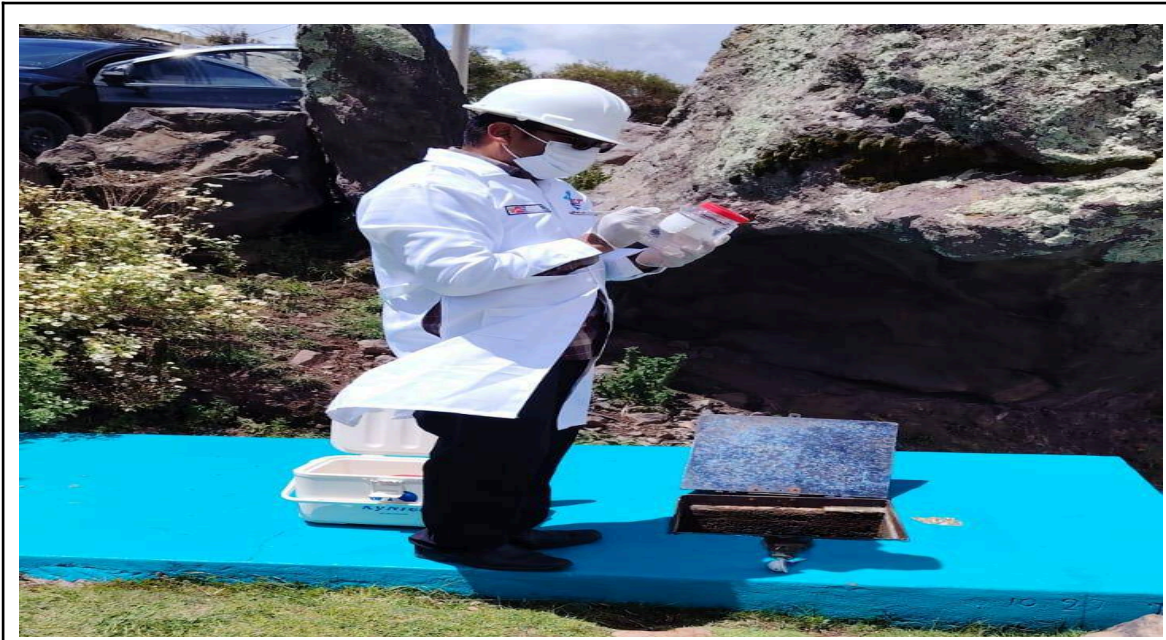
Figura 03. Identificación y control de muestras de agua durante el muestreo
