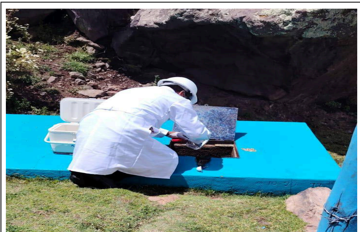
Figura 02. Procedimiento de toma de muestra de agua en el manantial
