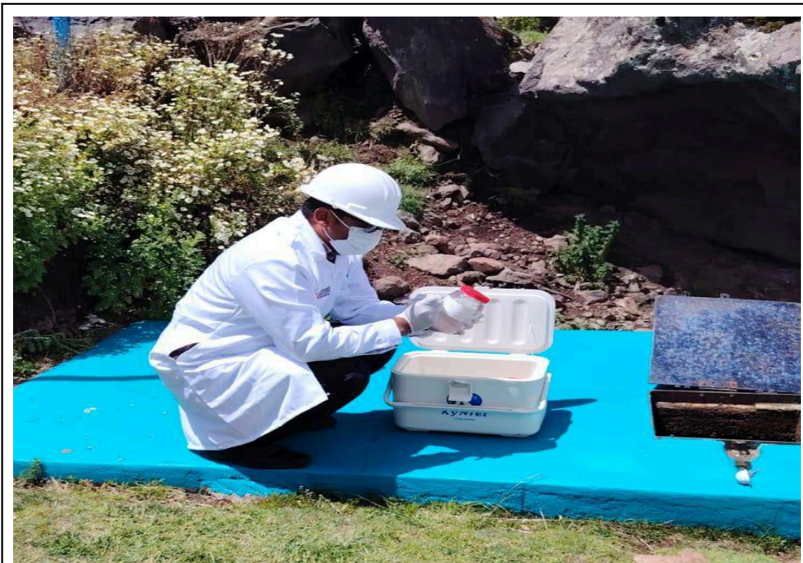
Figura 04. Conservación y almacenamiento de la muestra de agua en cadena de frío
