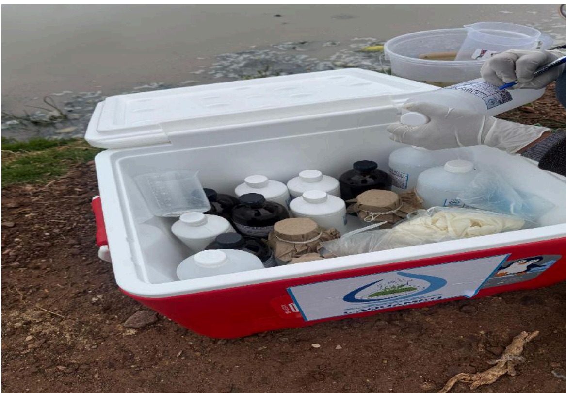
Figura 13: Rotulando y acondicionando los envases para la toma de muestras
