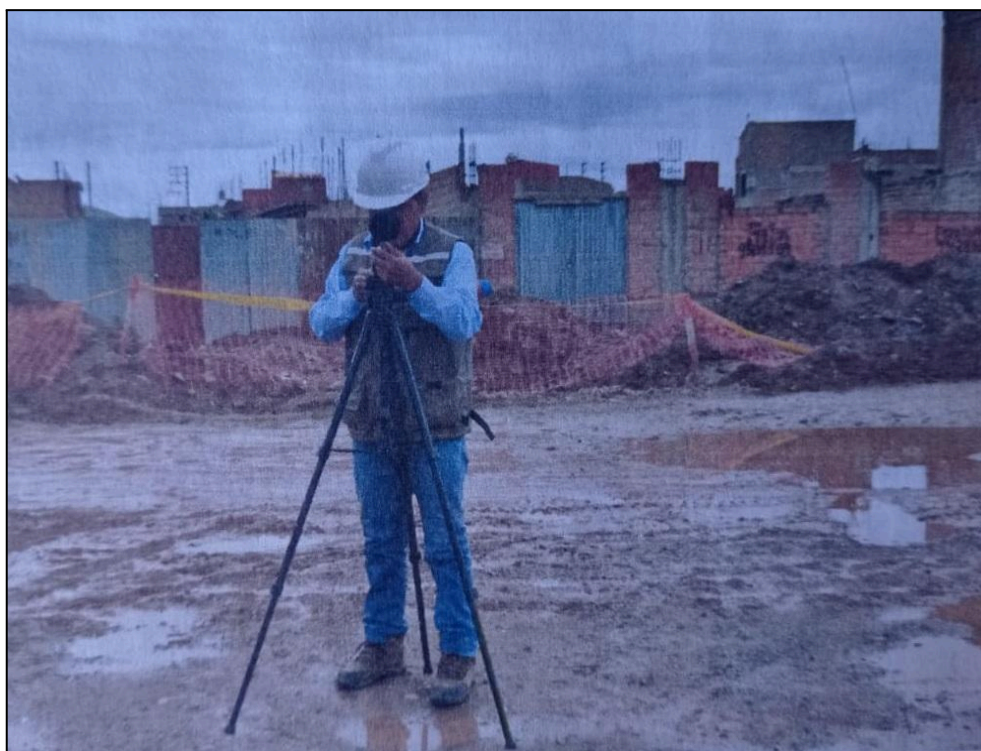
Figura 05: Instalación del sonómetro para el monitoreo de ruido.
