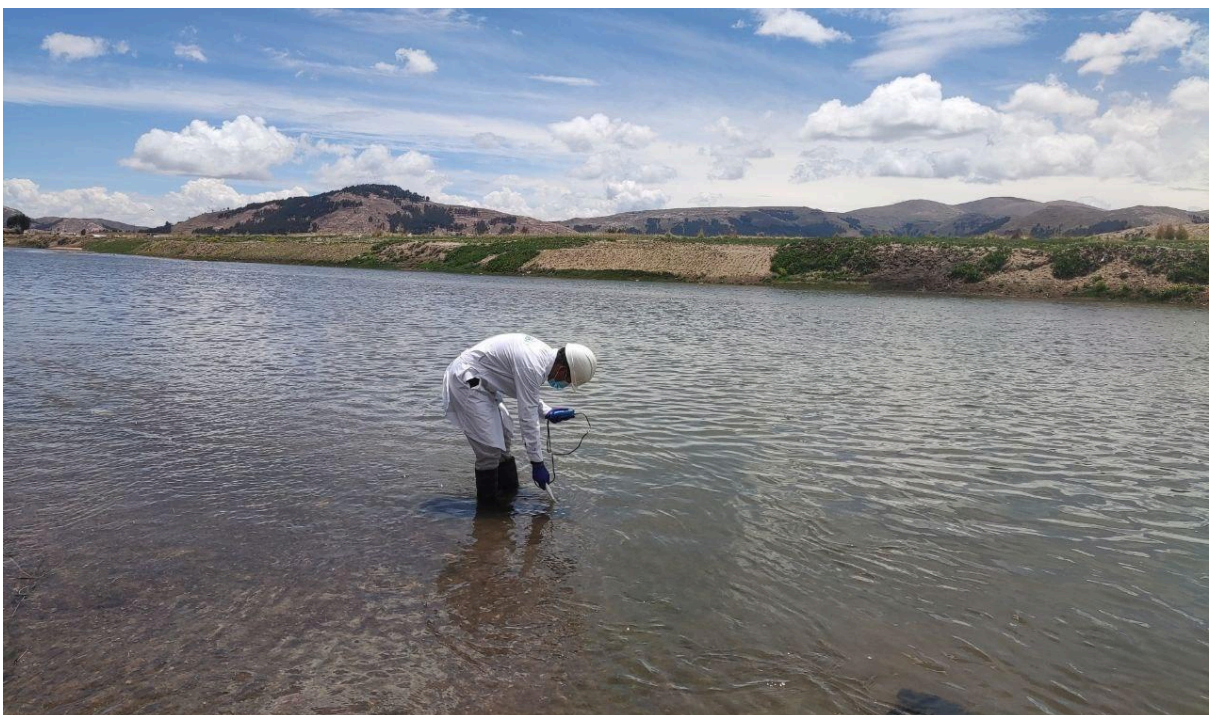
Figura 19: Toma de temperatura y parámetros de campo como pH y CE
