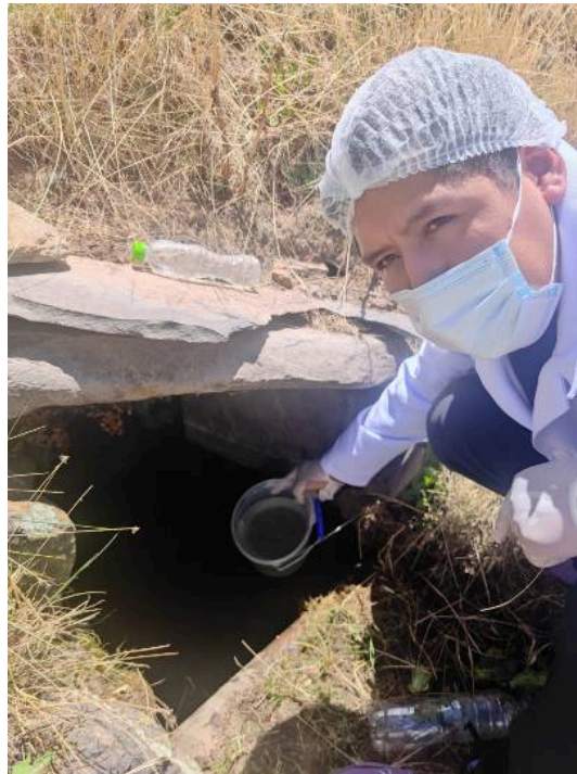
Figura 13: Toma de muestras del punto de captación del manantial del distrito de Vilque.
