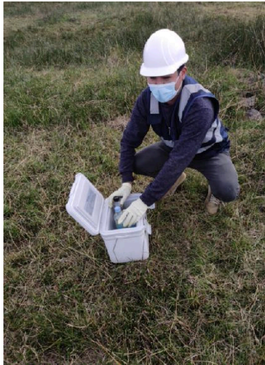
Figura 13: Toma de muestras del punto de captación del manantial de Tajquina.
