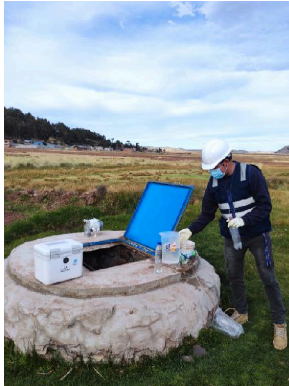
Figura 15: Toma de muestras del punto de captación manantial de Tajquina
