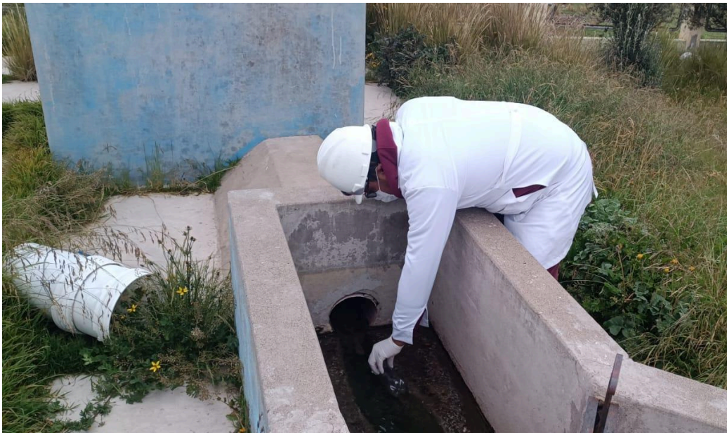
Figura 03: Primera toma de muestra en el afluente de la PTAR Sollocota.
