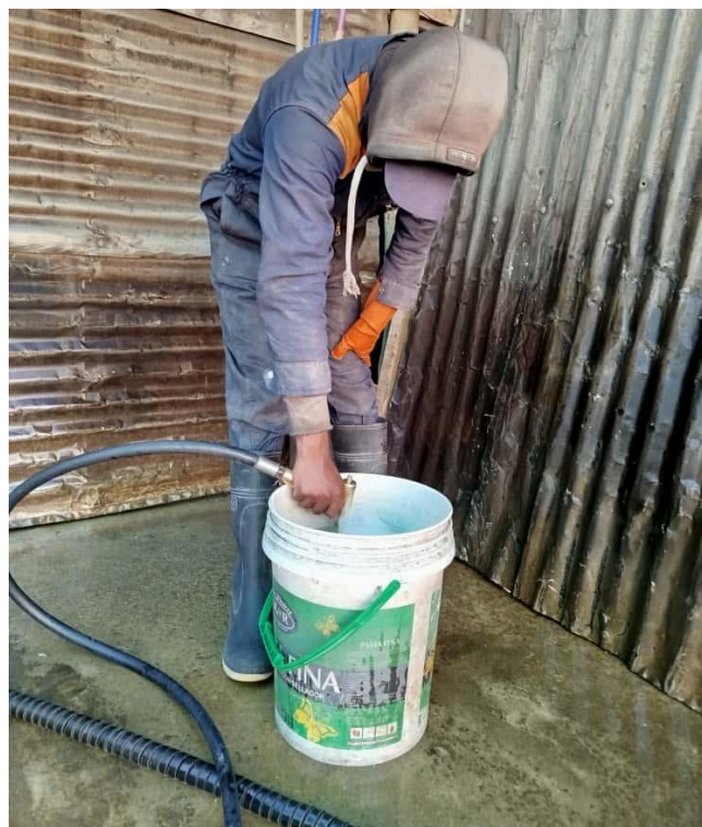
Figura 12: Llenado de contenedor de agua para el cálculo de gasto total del agua en local de autolavado.
