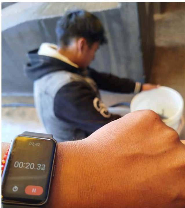
Figura 08: Medición del tiempo de llenado de contenedor de agua para evaluación y cálculo promedio.
