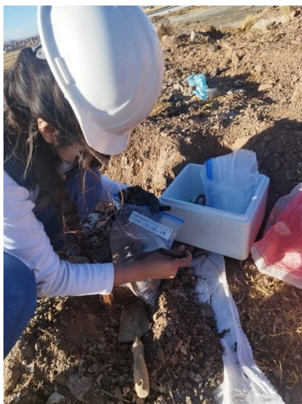
Figura 18: Almacenamiento temporal de muestras de suelo en bolsas etiquetadas.
