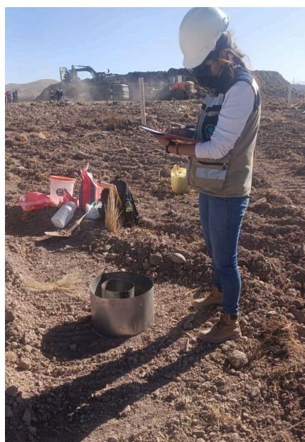
Figura 20: Pruebas del proceso de infiltración en suelos contaminados.
