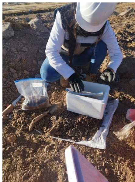
Figura 19: Rotulación de muestras de suelo en bolsas etiquetadas.
