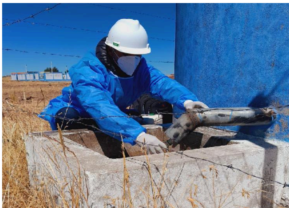
Figura 19: Toma de muestras en la captación (PM1) del sistema de distribución de agua potable del Centro Poblado De Challapujio Suyo.
