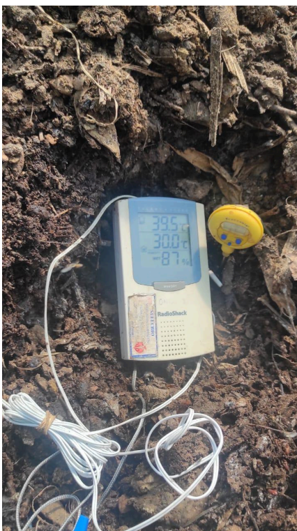
Figura 20: Control de la temperatura de la compostera.
