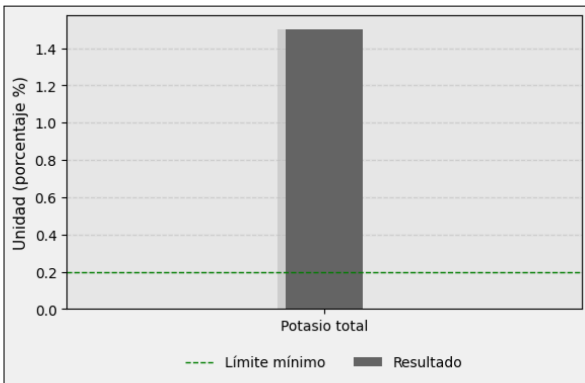
Figura 09: Comparación del potasio total con la NTP 201.208:2021.
