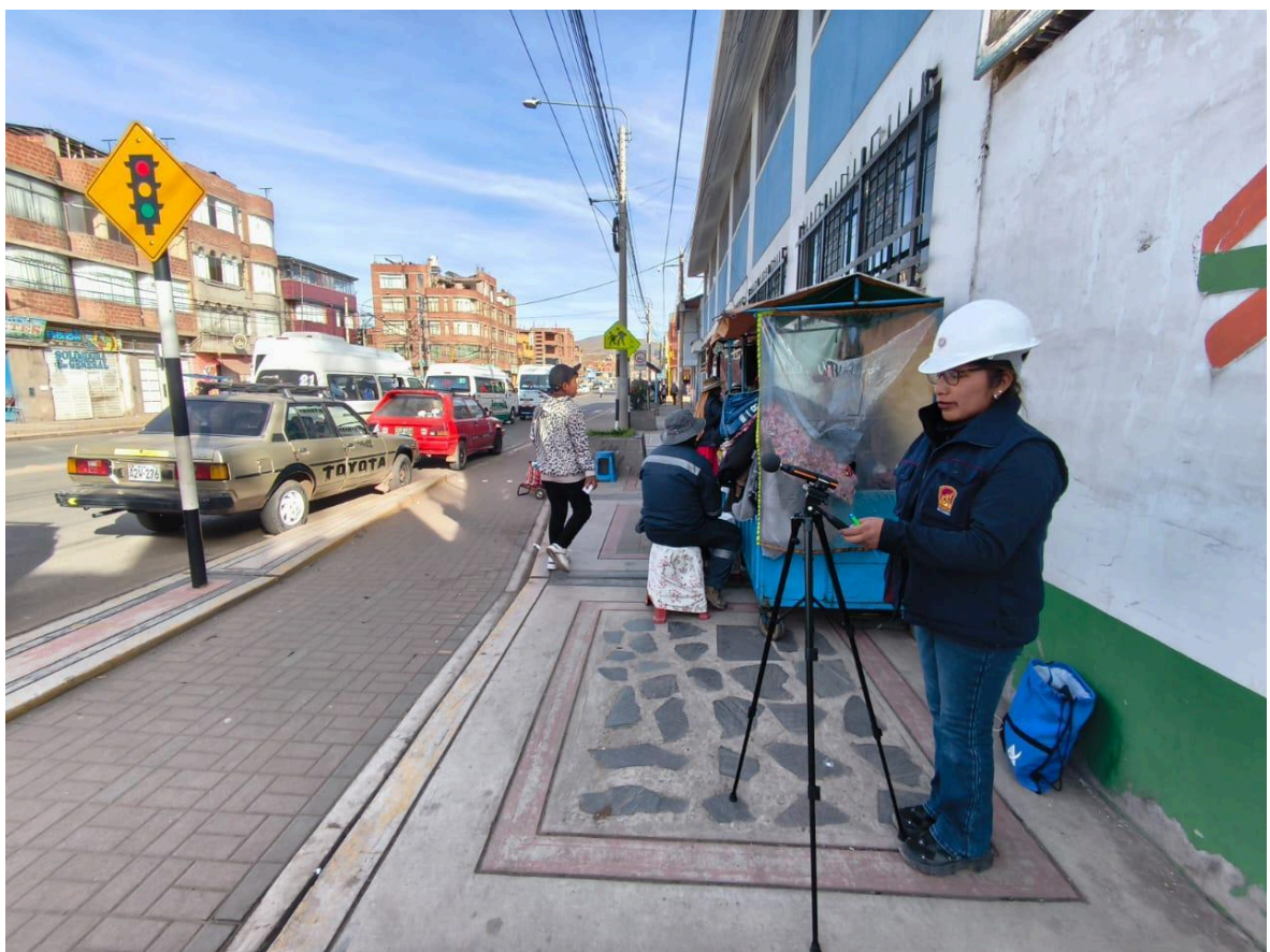
Figura 09: Medición del nivel sonoro en el PM - 1 .
