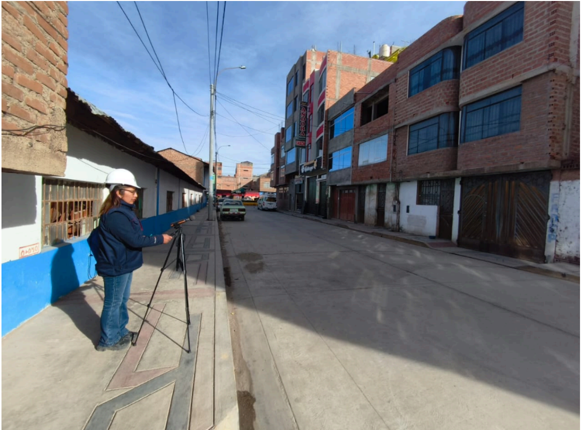
Figura 12: Medición del nivel sonoro en el PM - 4.
