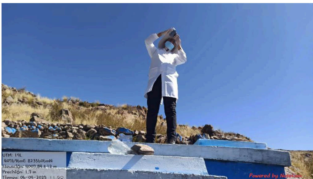
Figura 26: Medición de Cloro Residual Libre con Equipo HACH en el Reservorio de la red (PM2).
