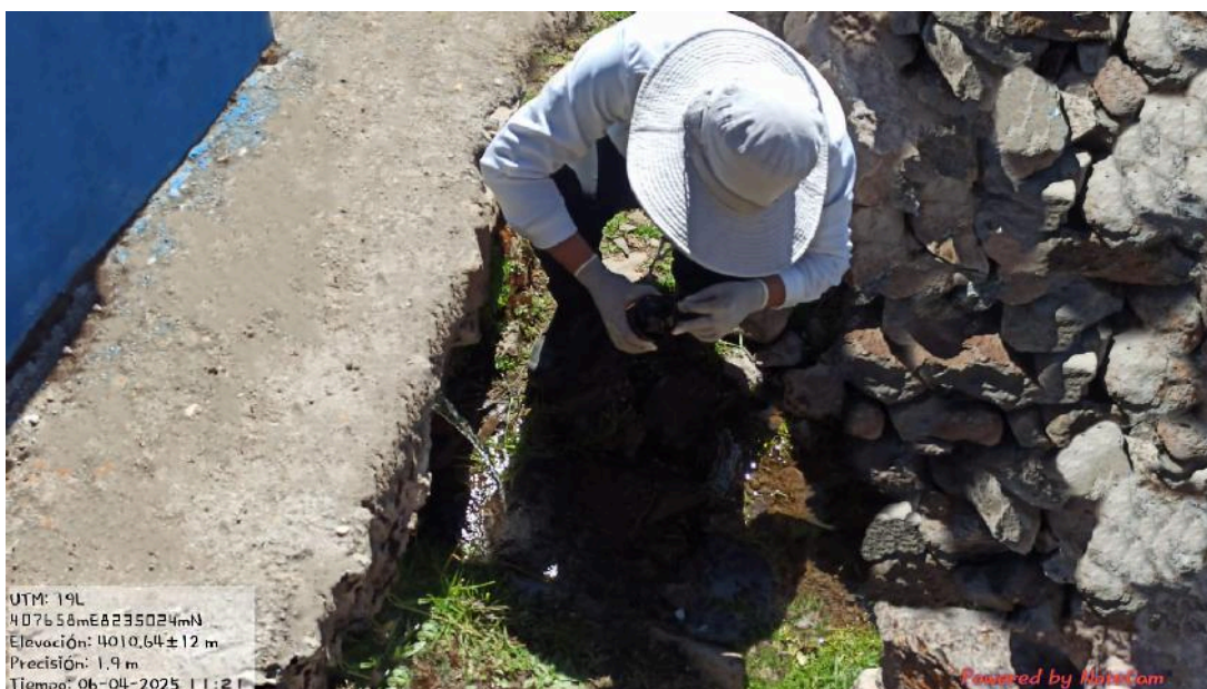
Figura 19: Recolección de Muestra de Agua para Análisis Microbiológico en la Captación (PM1).
