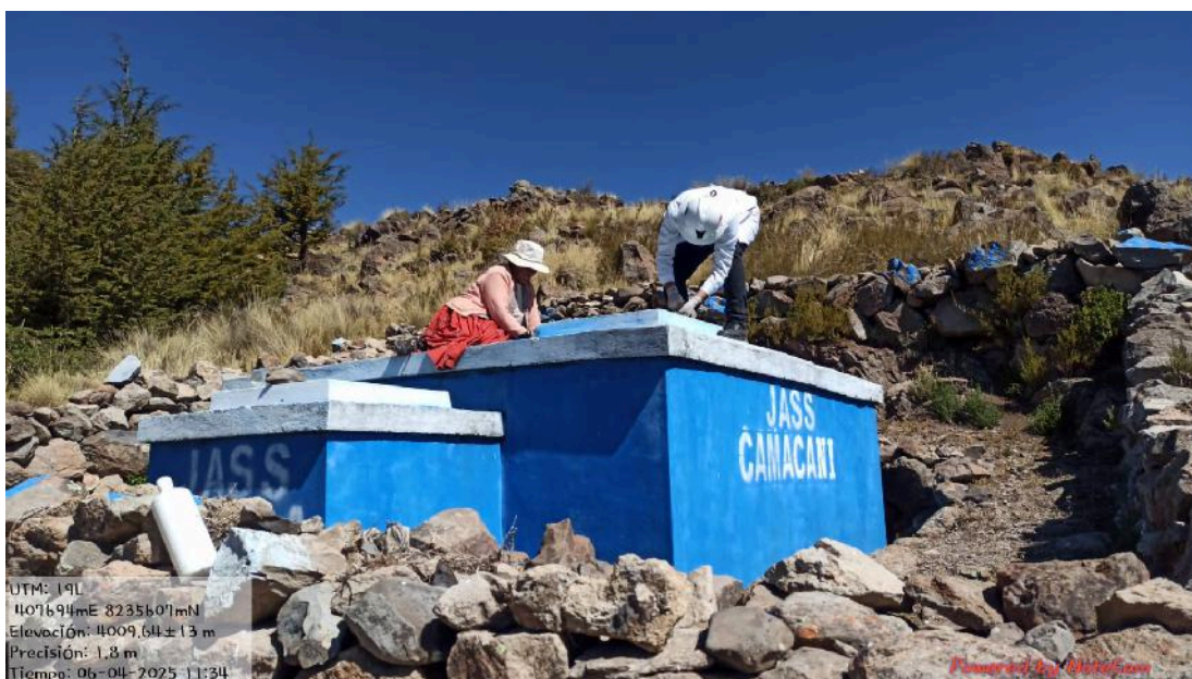
Figura 17: Apertura del Reservorio para Toma de Muestras en el Centro Poblado Camacani.
