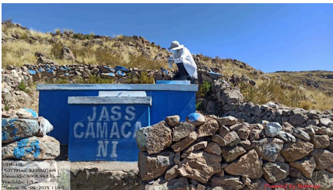
Figura 20: Toma de la Muestra de Agua para Análisis Físicoquímico en el Reservorio de la red de distribución (PM2).
