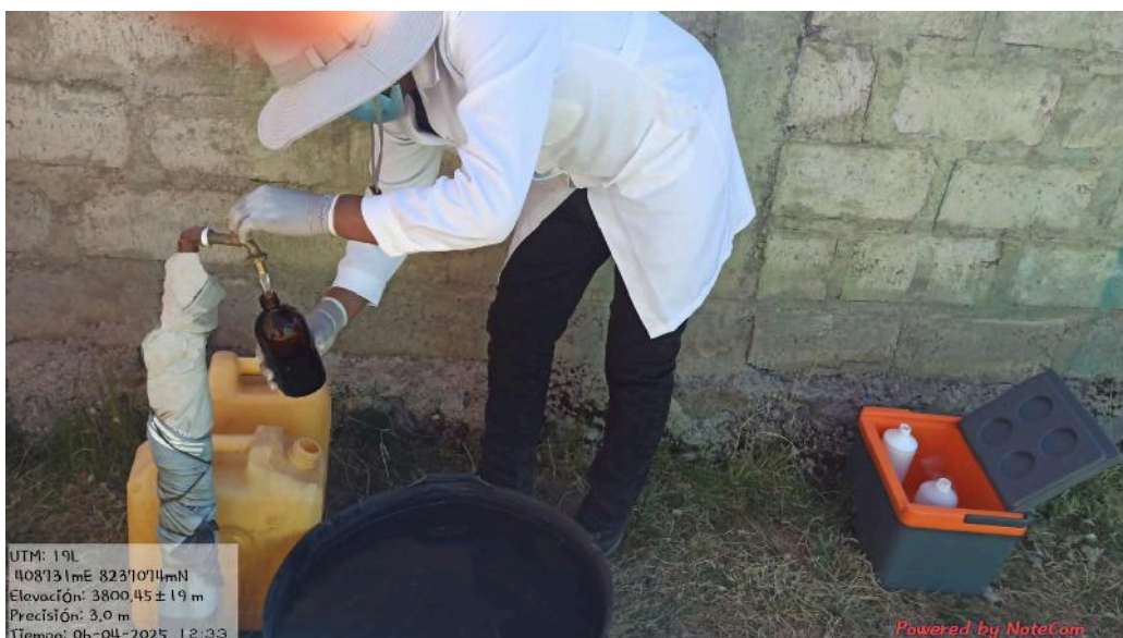
Figura 25: Recolección de Muestra de Agua para Análisis Microbiológico en la Última Vivienda (PM4).
