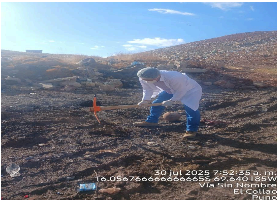
Figura 03: Haciendo un agujero para sacar la muestra
