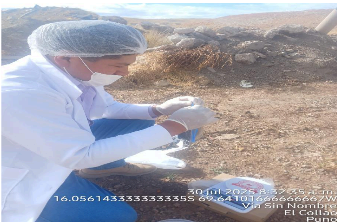
Figura 09: Sellando las muestras para llevarlas al laboratorio.
