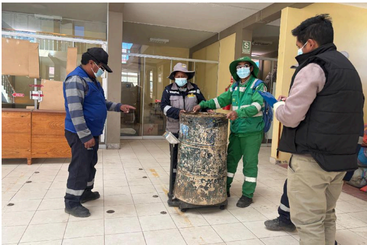
Figura 20: Pesaje de cilindro para medición de densidad de residuos sólidos.
