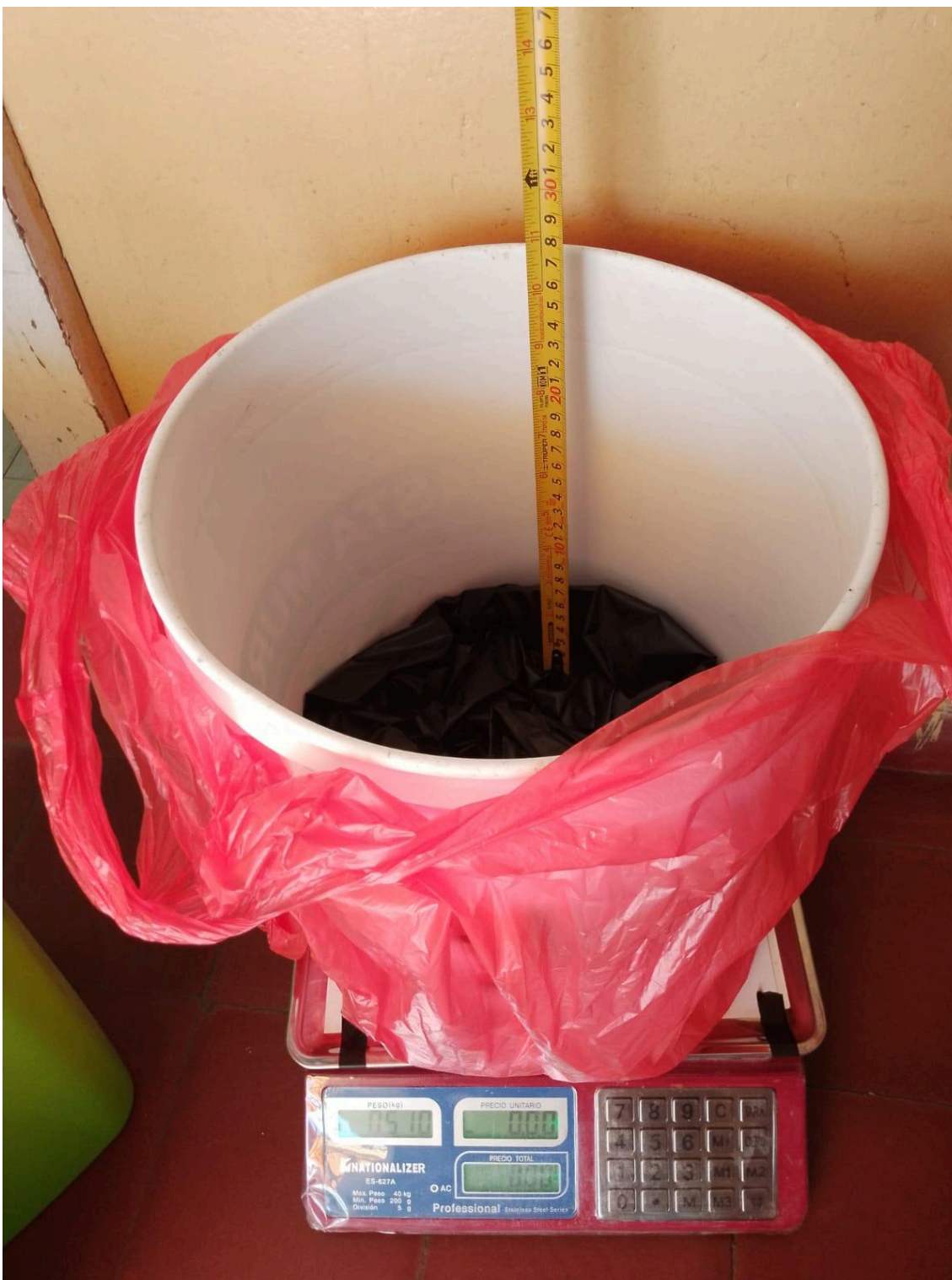
Figura 12: Registro del peso de los residuos comunes y altura libre Ho.
