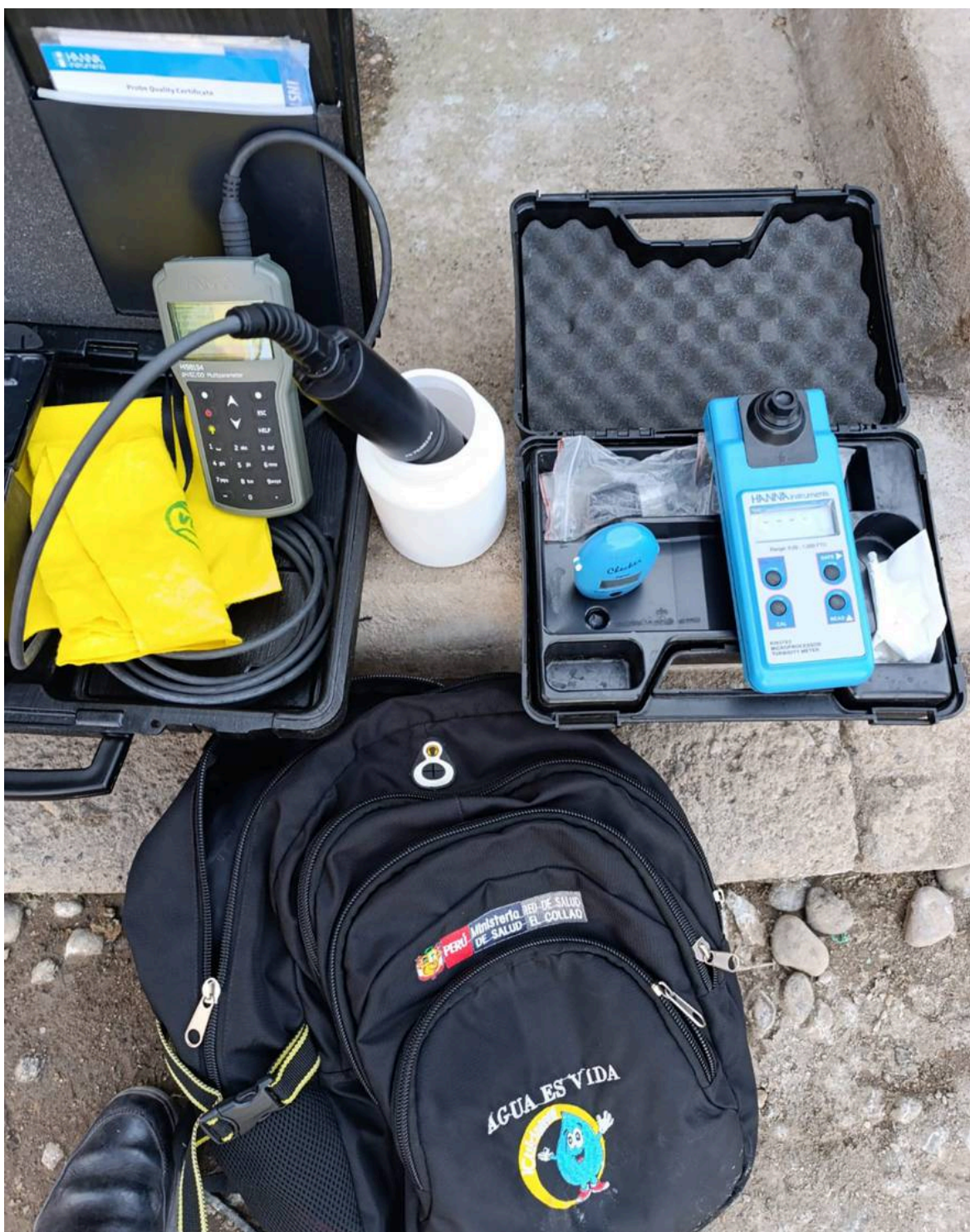
Figura 12: Equipos portátiles de campo para monitoreo.
