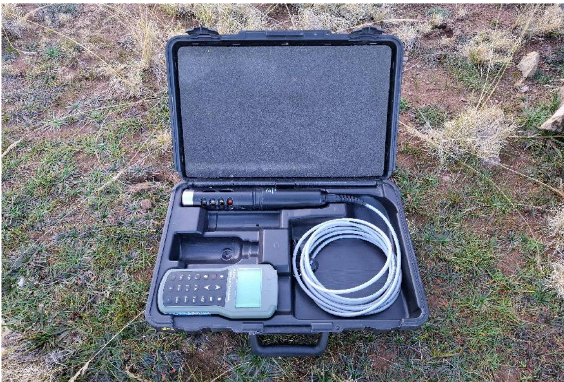
Figura 07: Multiparámetro Hanna, con capacidad de medición hasta 10 parámetros.
