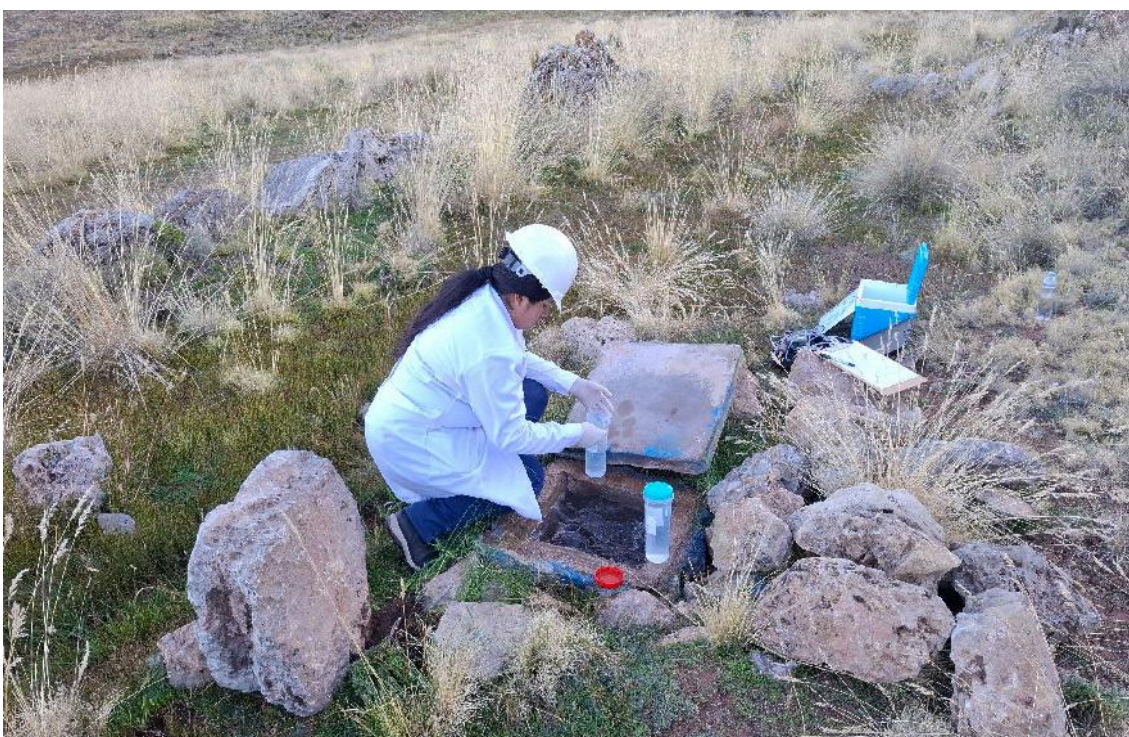
Figura 10: Toma de muestras para su traslado a laboratorio en el manantial de Jallpir Apacheta.
