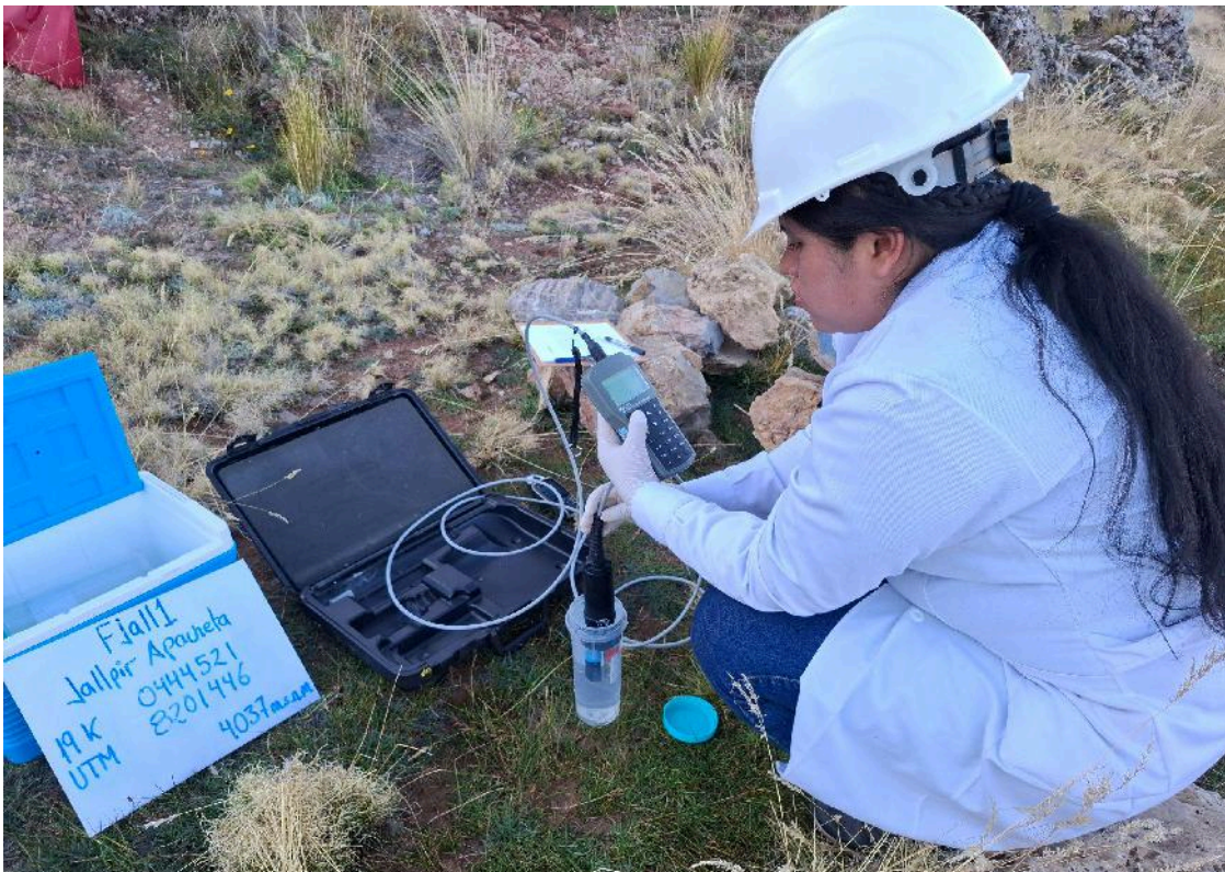
Figura 11: Medición de parámetros in situ, en el manantial Jallpir Apacheta.
