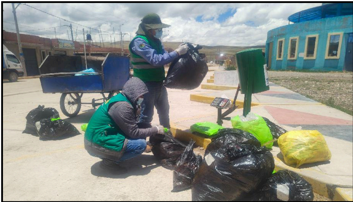
Figura 29: Peso de los residuos sólidos para medir densidad.
