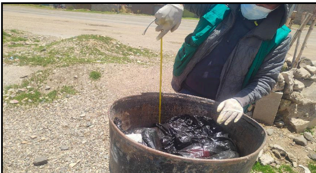
Figura 05: Determinación de la densidad de residuos municipales.
