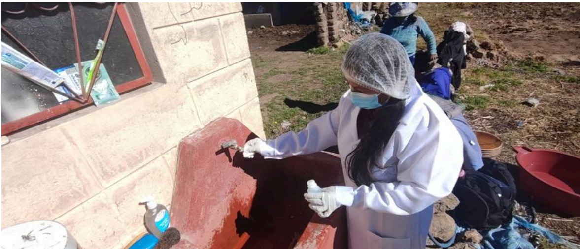
Figura 25: Desinfección del grifo para tomar muestra de agua
