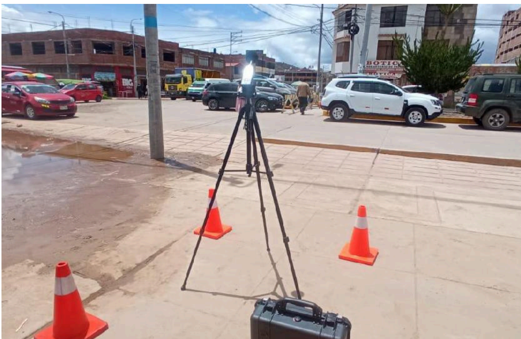
Figura 09: Instalación del sonómetro.
