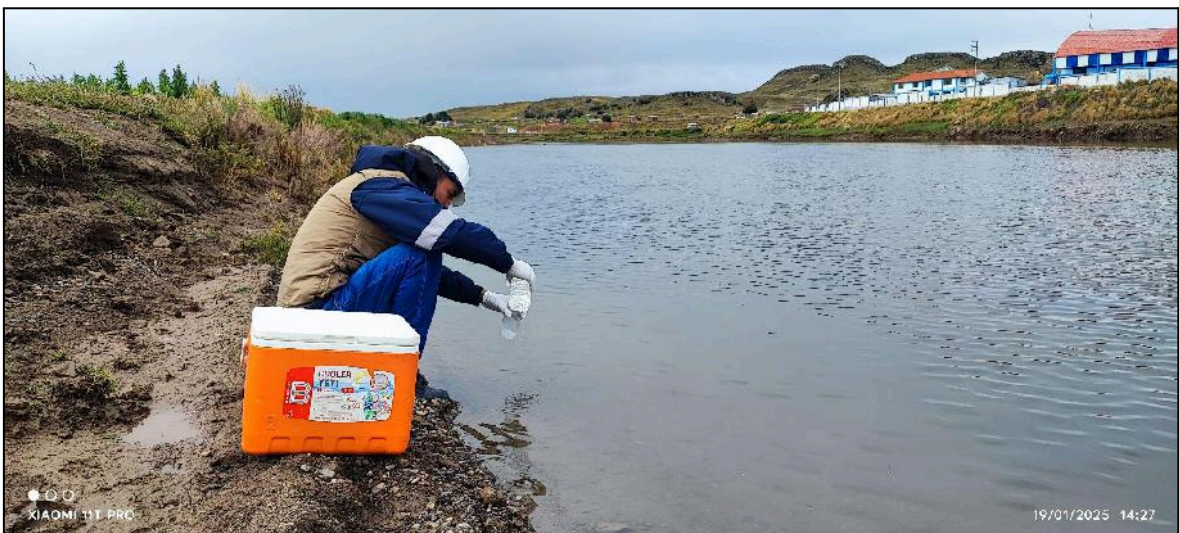
Figura 13: Recolección de muestras de agua superficial en el río llave – Punto M-3
