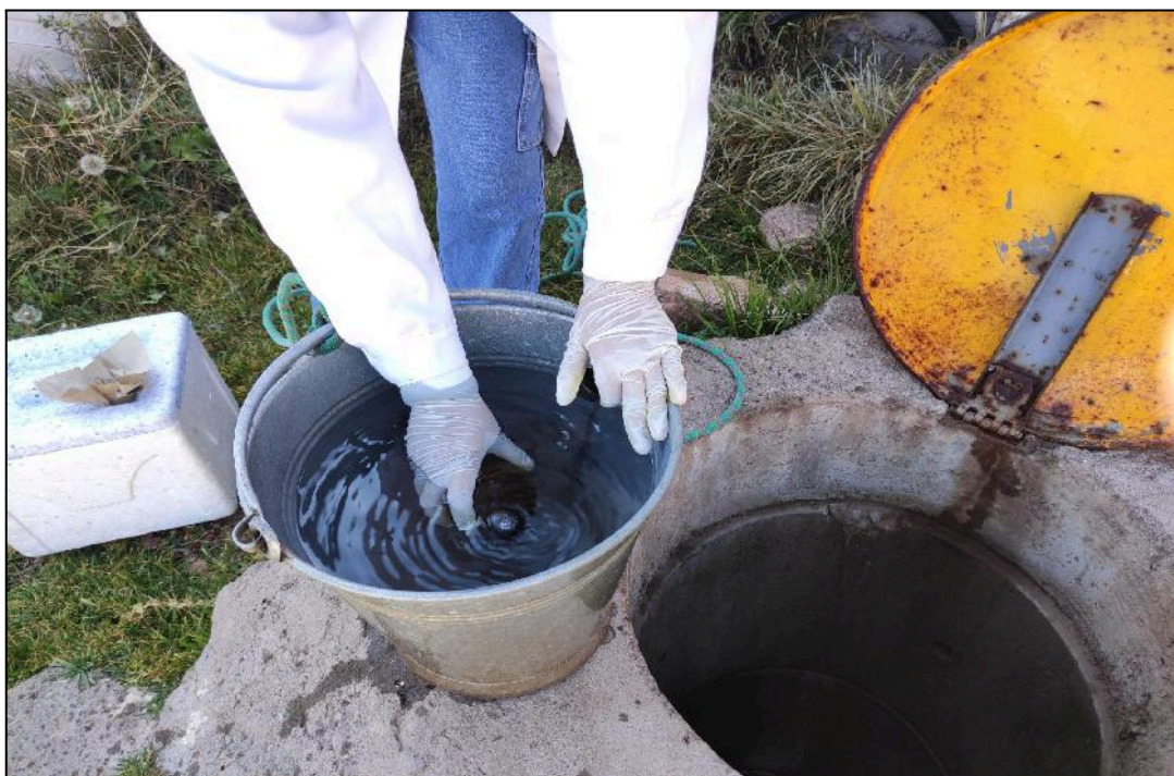
Figura 06: Toma de primera muestra en pozo para el laboratorio.
