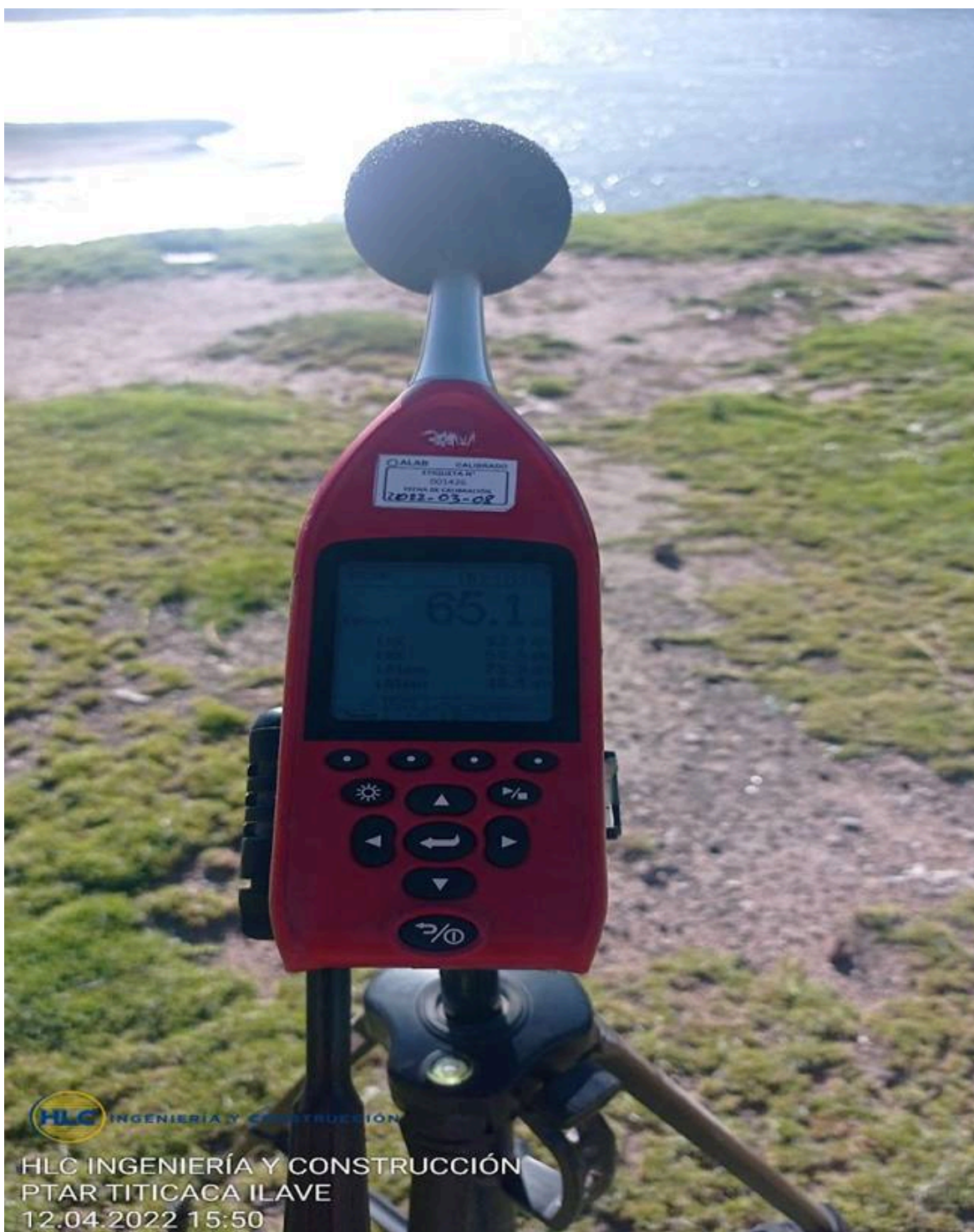
Figura 107: Sonómetro midiendo ruido en el punto RA-06, registrando niveles de ruido por encima del valor establecido en el ECA.
