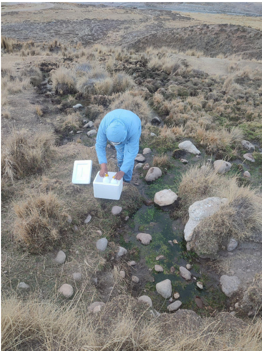
Figura 15: Colocando la muestra tomada en un recipiente hermético.
