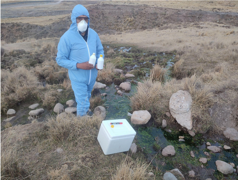
Figura 14: Mostrando la muestra para el análisis físico químico y para el bacteriológico.
