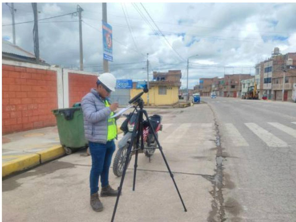
**Figura 31:** Llenado de registro de valores de dB mínimos, máximos y LAeq en la zona de protección especial.
