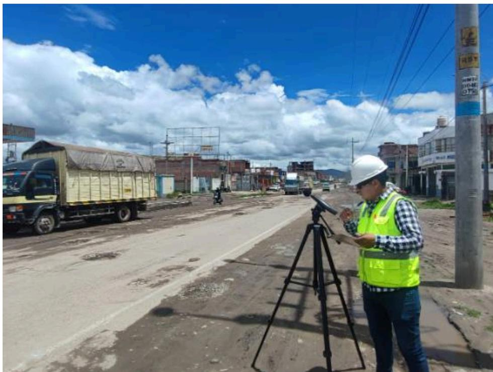
**Figura 30:** Llenado de registro de valores de dB mínimos, máximos y LAeq.
