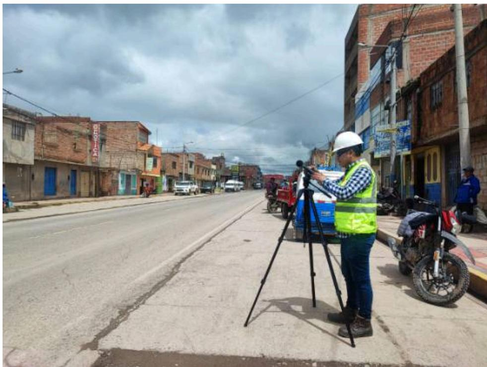
**Figura 26:** Programación del sonómetro para una medición de 10 minutos.
