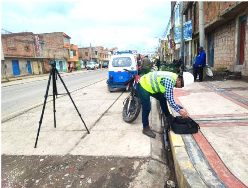
**Figura 24:** Instalación del sonómetro en campo.
