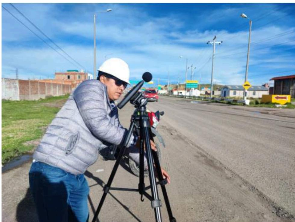
**Figura 25:** Ajustes del trípode a una altura de 1.5m.
