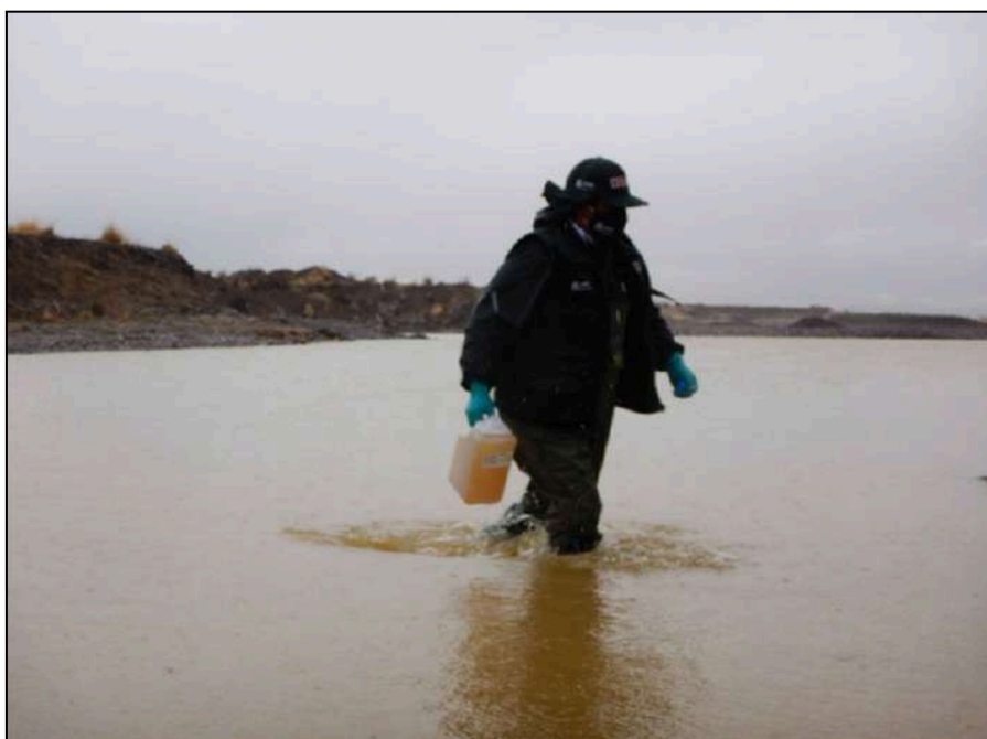
Figura 60: Toma de muestras de agua superficial en el río Llallimayo (RLlal2).
