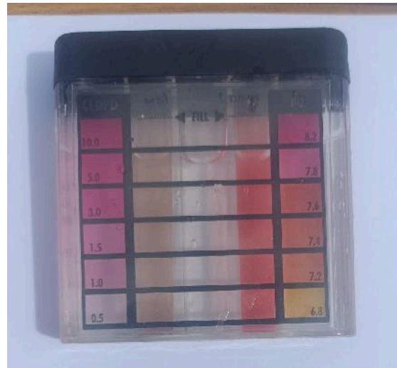
Figura 12: Comparación de la reacción inmediata del reactivo DPD1 en el PM-5, con el equipo comparador de cloro.
