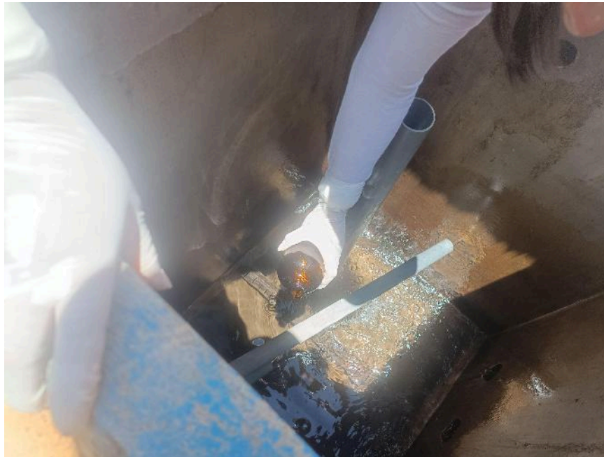
Figura 21: Toma de muestra de agua en el frasco de vidrio esteril neutro en el PM-2 correspondiente a la fuente de captación de agua N° 2.
