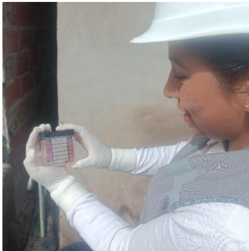
Figura 11: Pastilla reactiva de cloro libre DPD1 (N,Ndietyl p-fenileno-diamina) en la muestra de agua.
