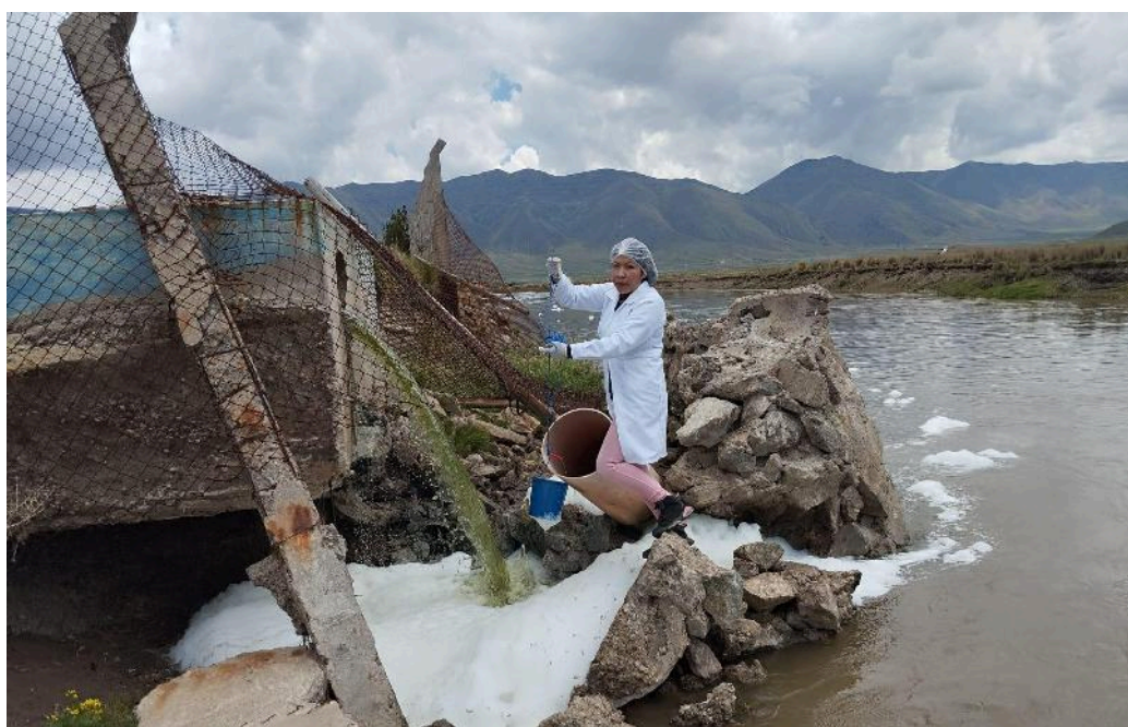
Figura 33: Toma de muestra de los parámetros en efluente de la PTAR de Ayaviri.
