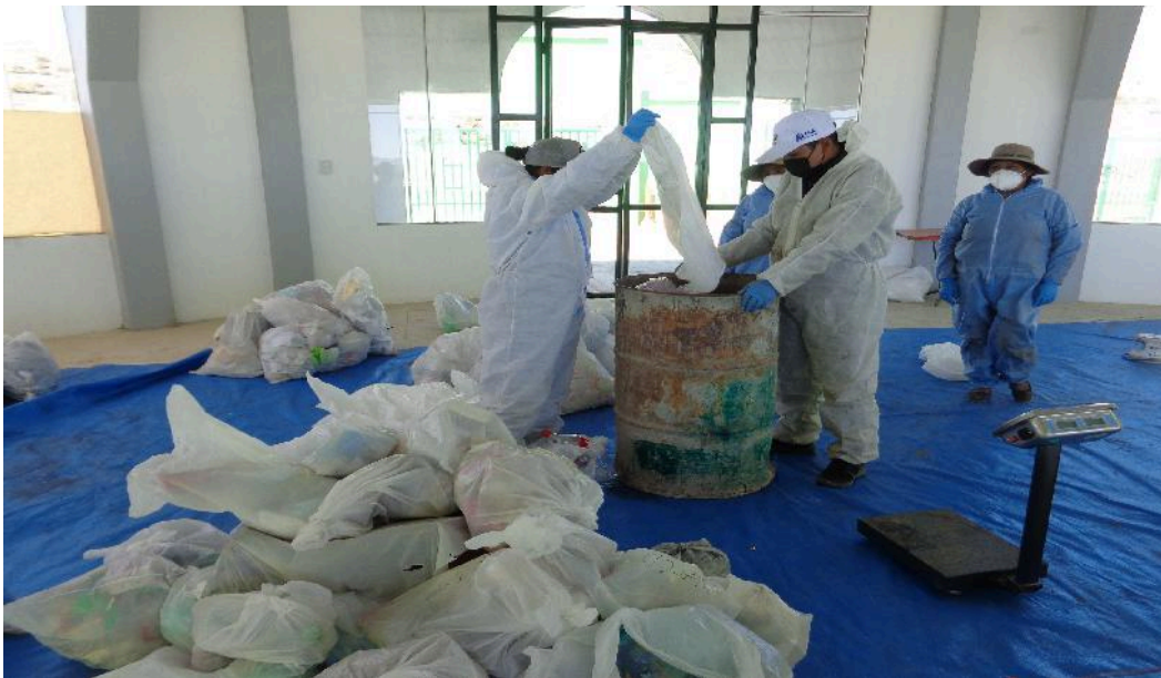
Figura 11: Preparación del recipiente para la determinación de la densidad de los residuos sólidos recolectados.
