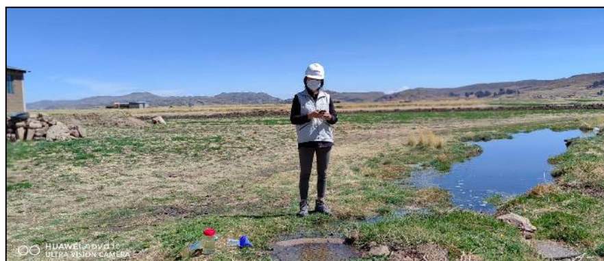
Figura 19: Medición de coordenadas con el GPS – Efluente Desembocadura
