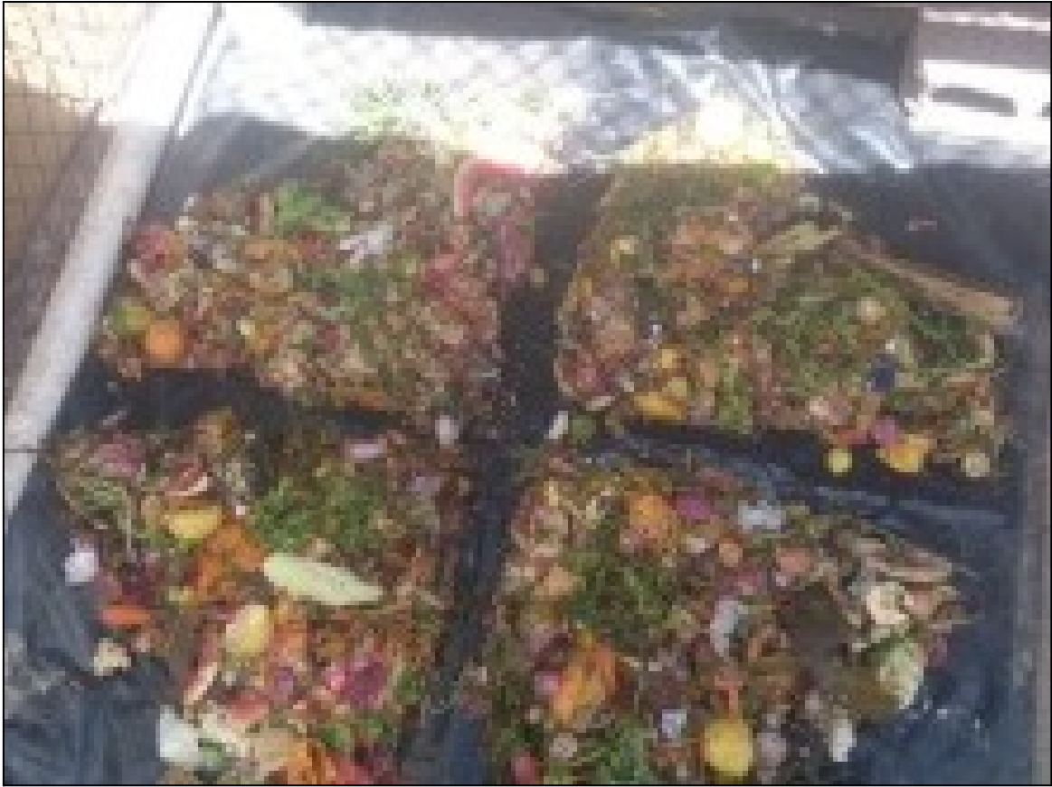
Figura 33: Método del cuarteo para los residuos sólidos.
