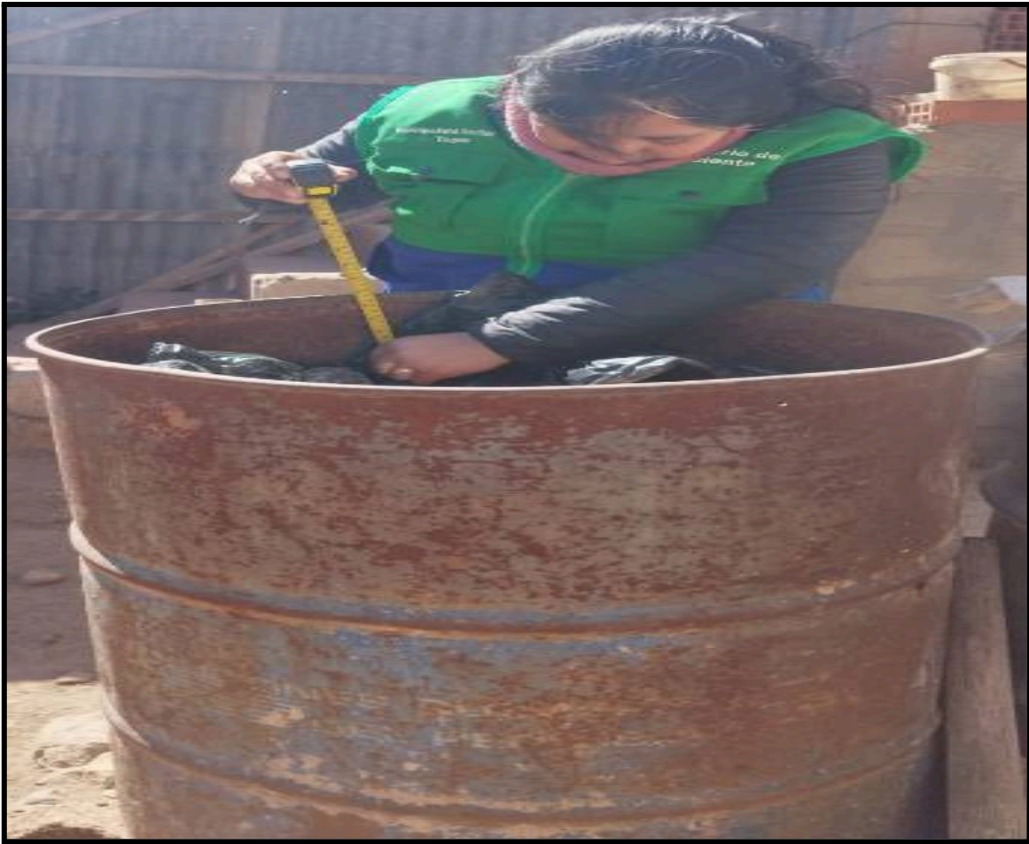
Figura 20: Medición de la altura libre del cilindro compacto
